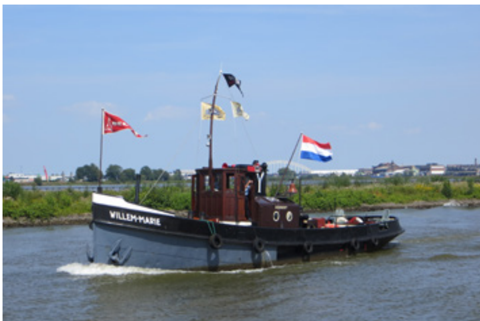
De sleepboot WILLEM-MARIE (02200097) van W. van IJsseldijk heeft al sinds 1938 thuishaven Dordrecht. Eerst als stoomsleepboot, maar sinds 1948 als motorsleepboot. In de machinekamer staat al 70 jaar een 375 pk sterke Deutz van het type REM 142.
