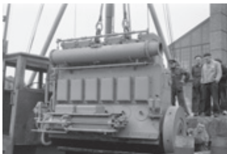
De nieuwe Bolnes-motor van de PAULA wordt bij de motorenfabriek aan boord geplaatst.
