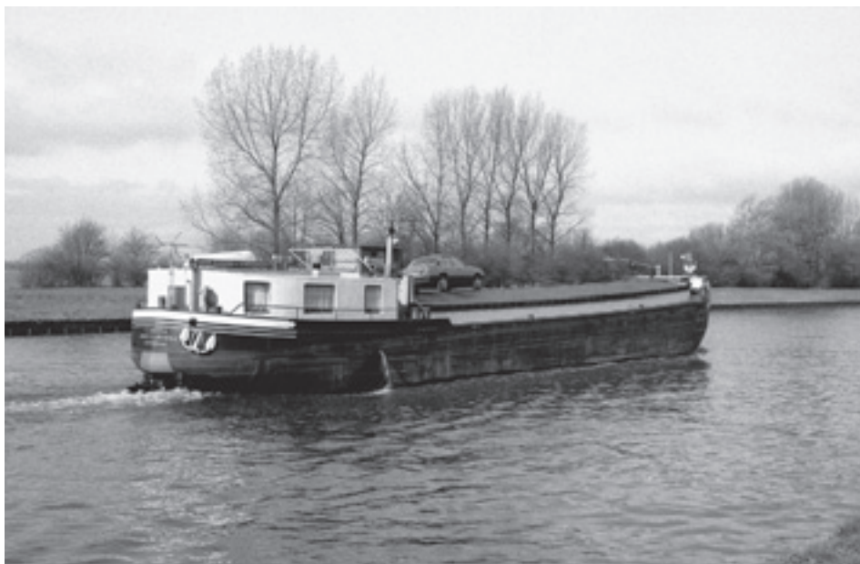
1961. ELNI, eigenaar J.P. Lonsdorfer. Dubbelschroef spits gebouwd met een Mayersteven, met 2 x 165 pk GM. Hier als DIRKJE BONNA.
