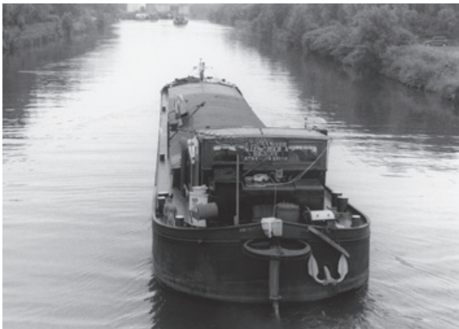
1955. LAC. D'AMOUR uit Oudenburg. Een typische Belgische spits, minstens 250 ton op 1,80 m diepgang en achter de stuurhut buiten de keuken.
