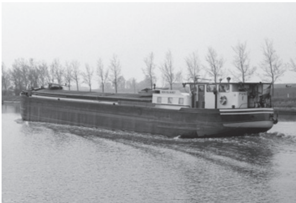
1948. NERI, gebouwd voor Franse rekening. Het schip heeft geen zeeg, wat in Frankrijk gebruikelijk was. Wel had dit schip al het karakteristieke eendenkontje wat bij Tielrode na de oorlog het meest werd gebouwd.
