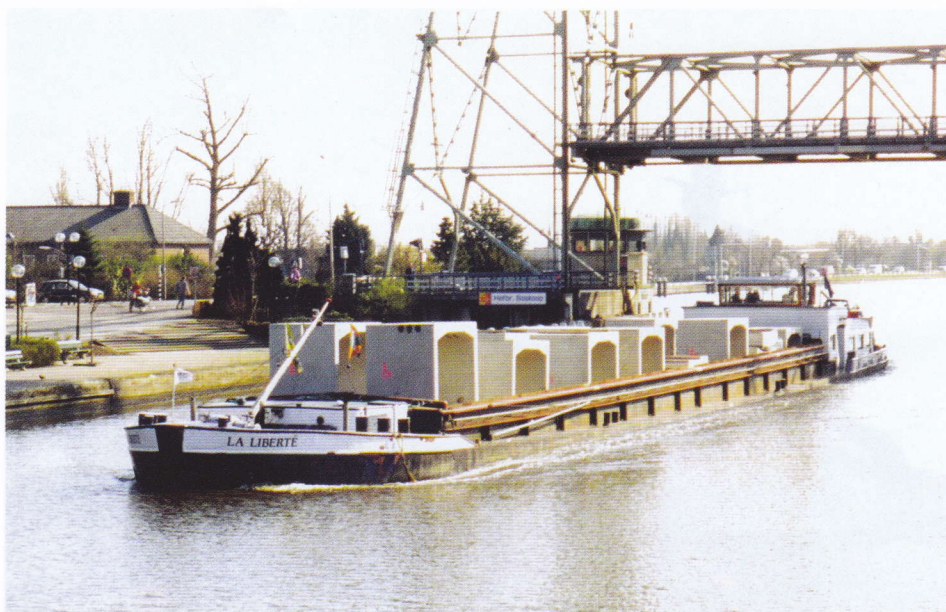
En ook de betonelementen voor diezelfde tunnel komen over de Gouwe. Gegevens van het schip LA LIBERTÉ: 66,95 x 8,20 x 2,51 m; 914 ton; 811 pk Cummins; boegschroef 168 pk DAF; bouwjaar 1960 als tankschip RUHRTANK 13 (Arminiuswerf, Bodenwerder). Tijdens deze foto uit 2003 is Siersack De Wit Vof uit Maasbracht eigenaar.
