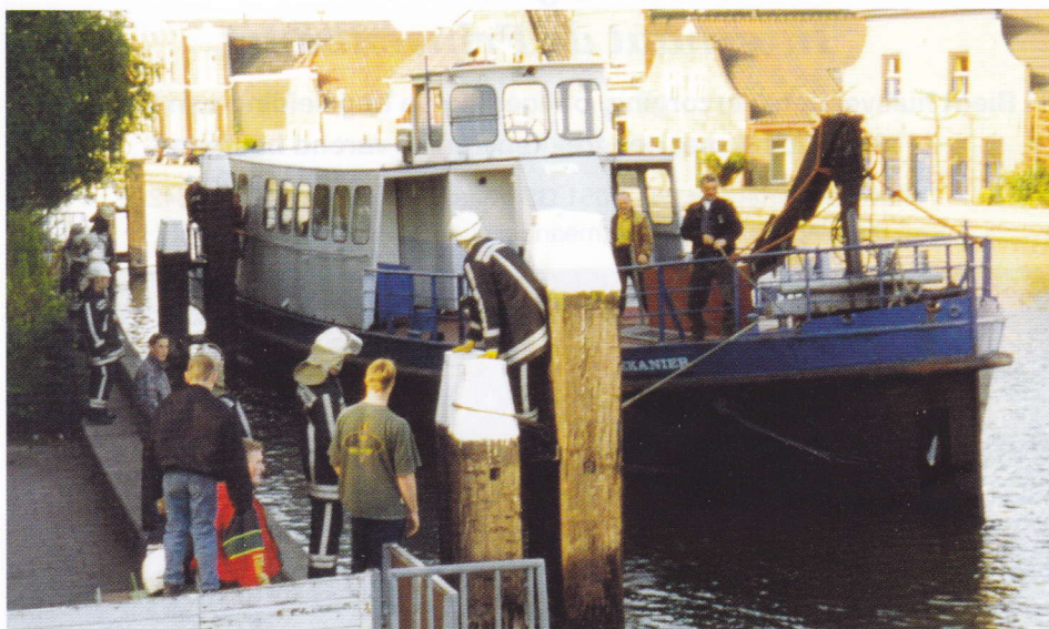
Op 21 april 1997 moet de Boskoopse brandweer komen pompen omdat de machinekamer van de BOEKANIER water maakt. Het scheepje werd in 1902 gebouwd met de afmetingen 26,75 x 5,45 m. In 1949 kwam er een 80 pk Industrie in. In de jaren-50 voer de boot als HEEN EN WEER X tussen Vlaardingen en de Petroleumhavens. Tijdens deze foto is de eigenaar onbekend.
