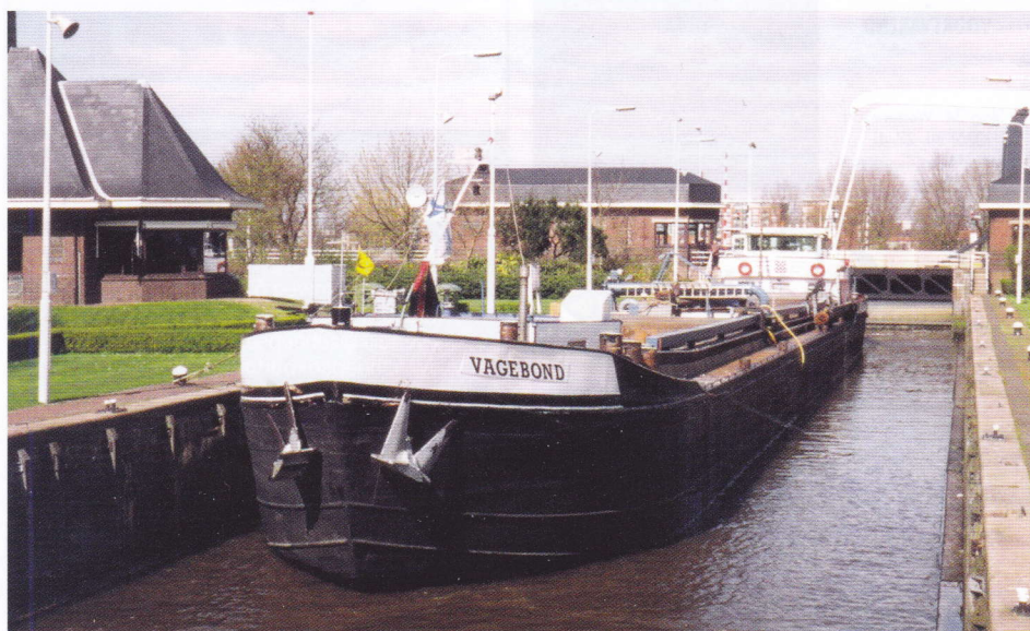
Beunschepen zie je vaak op de Gouwe. Hier het motorbeunschip VAGEBOND uit Nijmegen op 6 april 2000 in de Julianasluis. Sinds de bouw in 1965 bij Gelria in Nijmegen had het 85,00 x 8,20 x 3,03 m en 1312 ton metende schip al diverse andere namen en eigenaren. Rest nog de motor te vermelden: een Deutz van 870 pk.
