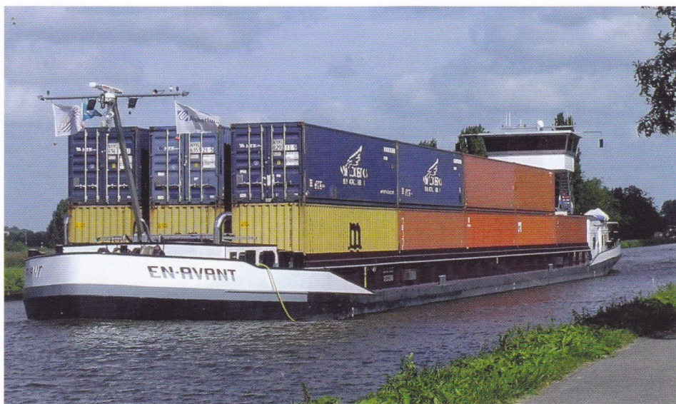
Sinds het gereedkomen van de containerterminal in Alphen a/d Rijn nam het containertransport over de Gouwe enorm toe. Hier de EN-AVANT van Vof Den Ouden De Jong uit Krimpen a/d IJssel, die 90 teu kan meenemen. Verder: 85,77 x 10,00 x 2,96 m; 1608 ton; 862 pk Mitsubishi (+ boegschroef); afbouw 2010 bij Buijs in Krimpen a/d IJssel op casco uit China.
