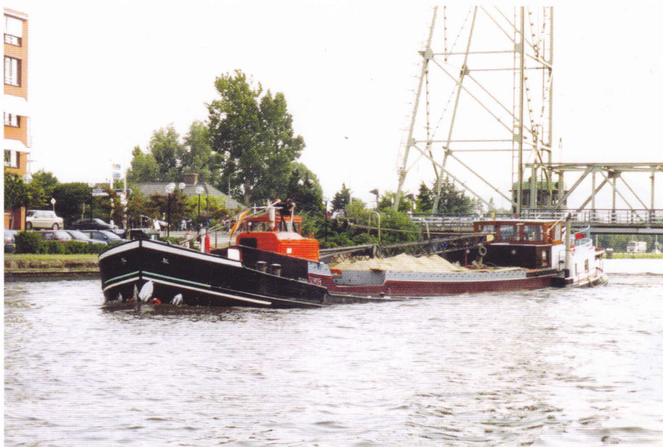
Op de VAGO RESTE van P. van den Berg uit Elst staat een kraan om zelf te kunnen lossen. Dat zal na de bouw in 1932 als SPES op de werf van Barkmeijer vast nog een traditionele zelfflosser zijn geweest. Gegevens: 37,30 x 5,39 x 2,21 m; 244 ton; 141 pk Stork Ricardo. De foto stamt van 28 augustus 2002.
