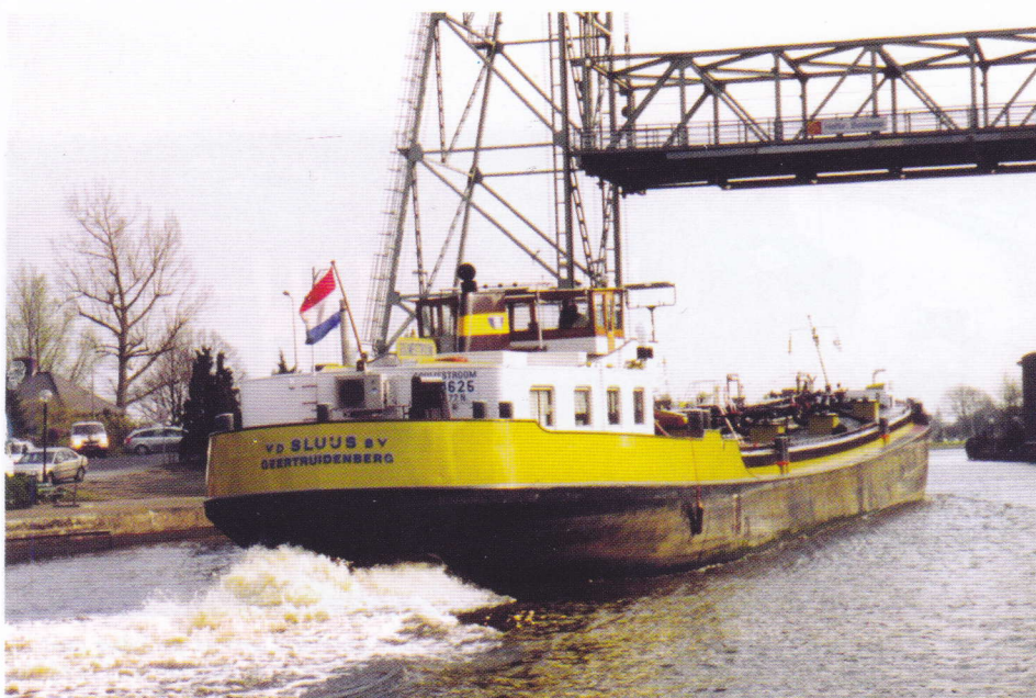
Nog een schip met de naam GOUWESTROOM op de Gouwe. Het is een tanker van rederij Van der Sluijs uit Geertruidenberg die het 905 ton metende schip in 1972 bij Kooiman in Zwijndrecht liet bouwen. De Bolnesmotor van 501 pk staat zo te zien vol aan. Verdere gegevens: 73,27 x 8,18 x 2,52 m.
