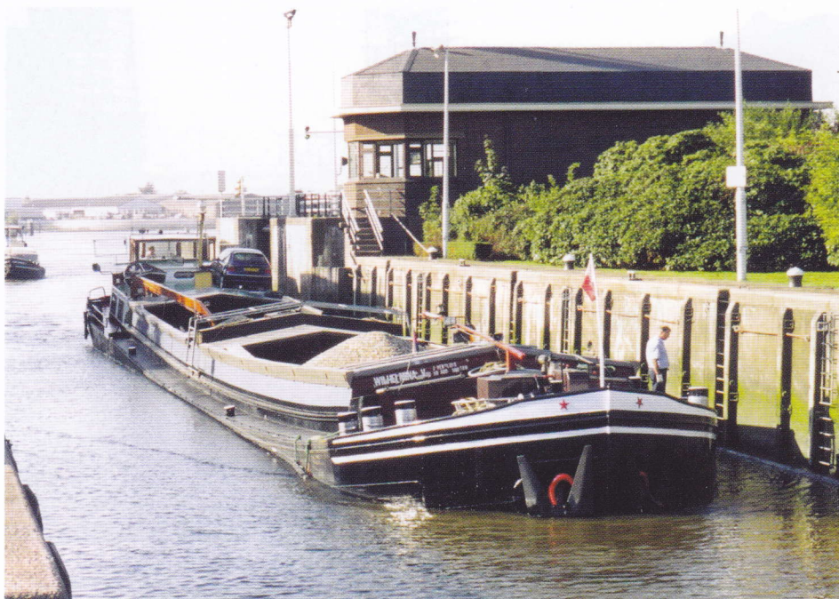
Op 22 september 2003 manoeuvreert schipper J. Versluis uit Werkendam zijn met grind geladen WILHELMINA van de Julianasluis in. Ook al weer zo'n beeld dat nu, anno 2016, een zeldzaamheid is geworden. Gegevens: 49,92 x 6,59 x 2,42 m; 510 ton; 306 pk Caterpillar en 206 pk DAF-kopschroef; bouwjaar 1916 bij 'Vooruit' in Enkhuizen.
