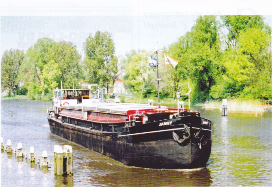
Schipper Steenbergers uit 's-Gravendeel is met zijn 503 ton metende JANNY op het Gouwekanaal bij Gouda op de foto gezet in april 2009. Op drie jaar na was het schip toen een eeuw oud: het werd in 1912 bij De Jong & Smit in IJsselmonde gebouwd. Verdere gegevens: 49,40 x 6,58 x 2,40 m; 245 pk GM + kopschroef 190 pk DAF.
