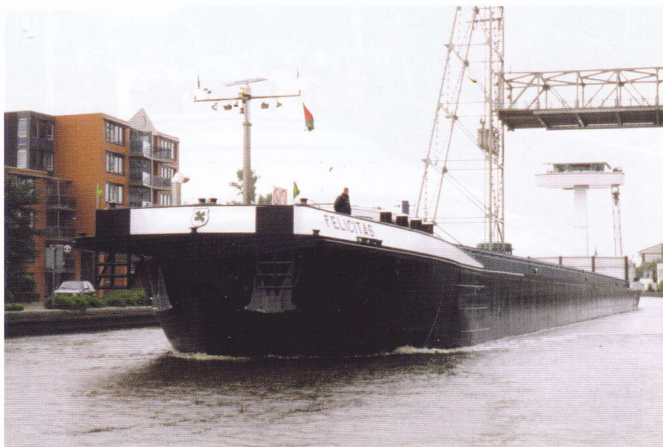
Op 14 september 1998 vindt een proefvaart op de Gouwe plaats met een groot containerschip. Het is de FELICITAS van K. de Jong uit Hardinxveld (110,00 x 11,40 x 3,50 m; 2705 ton; 2100 pk ABC, bouwjaar 1995, Otlenita in Roemenië).
