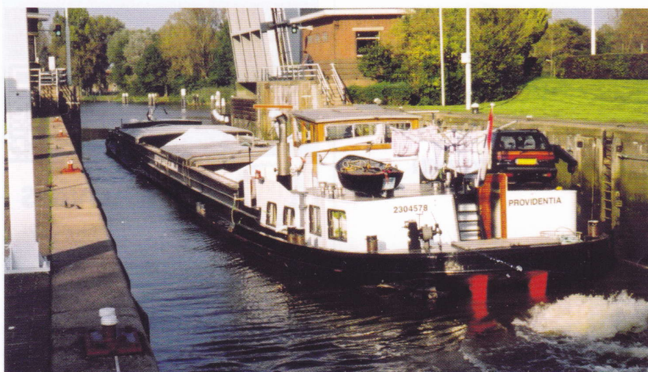
In 1929 werd het sleepschip ST. FRANCISCUS bij De Groot & Van Vliet in Slikkerveer gebouwd. Omgebouwd tot motorschip in 1964 en diverse namen verder vaart het hier als PROVIDENTIA in oktober 2005 de Julianasluis uit. Gegevens: 67,00 x 8,20 x 2,37 m; 852 ton; 550 pk Caterpillar (boegschroef 272 pk); eigenaar: Pomp-Mulder Vof, Krimpen a/d IJssel.
