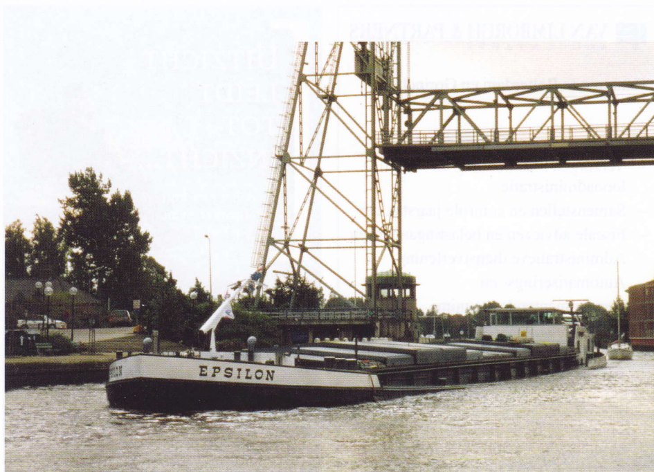
Aan de boeg laat ook dit schip zich verraden als een voormalig rederijsschip: de EPSILON van schipper V.d. Elshout uit Zwijndrecht ging in 1958 bij Hitzler in Lauenburg van de helling als de tanker MOGUNTIA van Van Ommeren. Op de foto uit 2001 meet het droge-ladingschip 79,91 x 9,45 x 2,82 m en 1406 ton. Een Caterpillar van 973 pk beweegt het schip voort.
