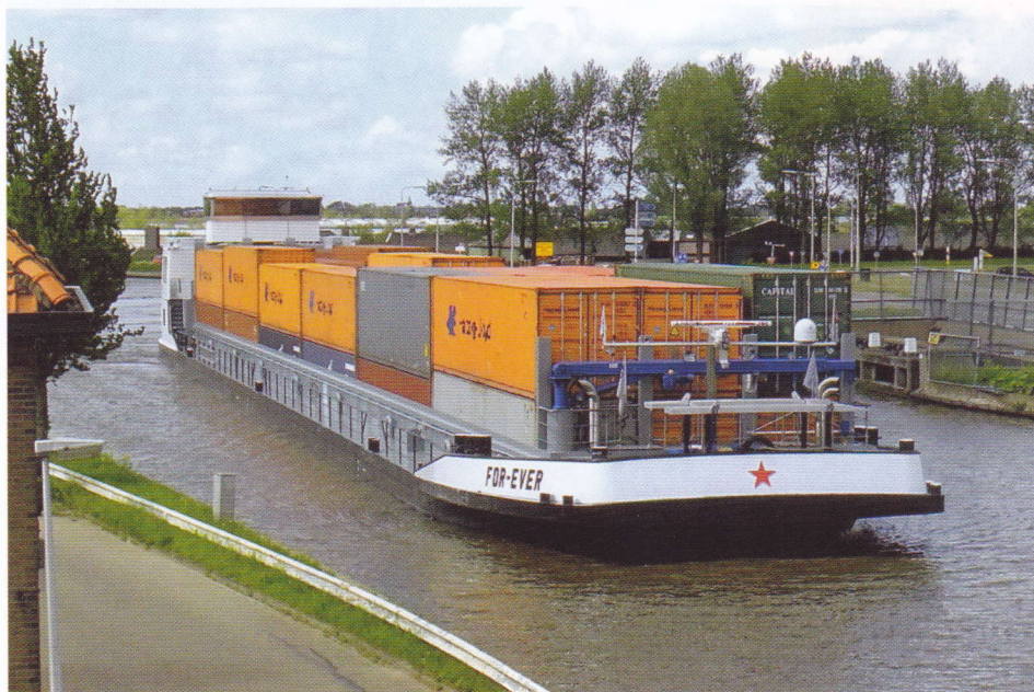
De FOR-EVER van M. van der Knaap uit Krimpen a/d Lek werd speciaal voor de Gouwe ontworpen en wordt dan ook 'Gouwenaar' genoemd. Gegevens: 90,00 x 10,50 x 3,00 m; 1883 ton; 104 teu; 2 x 525 pk Scania; afbouw 2012 bij Jooren in Werkendam op casco uit Roemenië.
