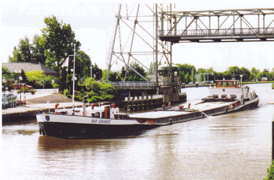
De RIO GRANDE heeft al vanaf de bouw in 1970 bij Van Duijvendijk in Krimpen a/d IJssel tot op de dag van vandaag dezelfde naam gehouden. De Boskoopse brug is vermoedelijk al honderden keren omhoog gegaan voor dit schip, zoals op deze foto uit 2002, toen het beunschip nog eigendom was van de firma Rook uit Krimpen a/d IJssel. Gegevens: 69,94 x 8,21 x 2,82 m; 997 ton; 660 pk MAK, boegschroef 142 pk DAF.
