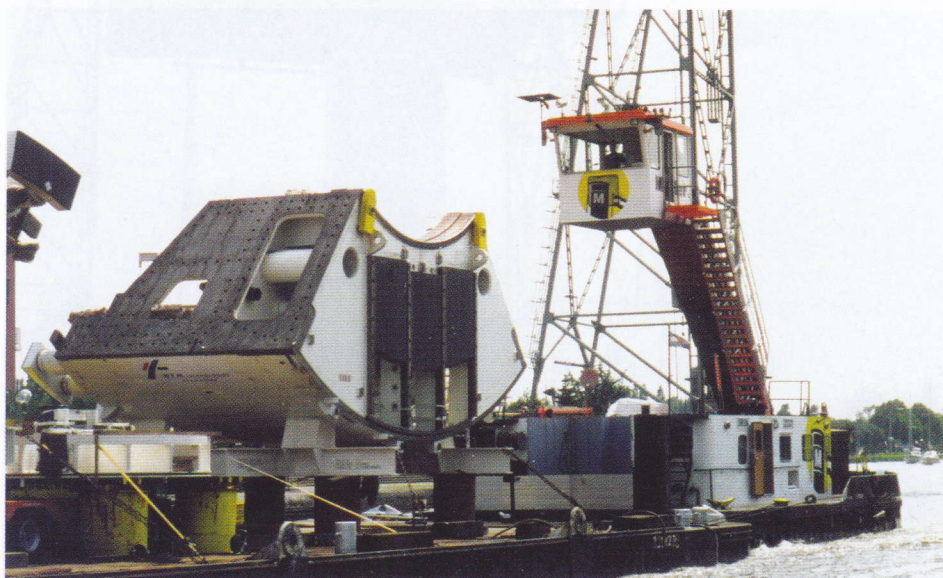
Op 17 juli 2001 passeert een groot element voor de boorinstallatie van de tunnel onder het Groene Hart voor de hogesnelheidstrein. De duwboot is de ORION van Muller Zwaartransport uit Dordrecht met de afmetingen 15,13 x 9,46 x 1,70 m. Er staat 2 x 480 pk Caterpillar in. Ooit behoorde deze duwboot tot de eerste serie kleine Franse duwbotten met Schottel-aandrijving. Deze boot heette toen SEMOIS, in 1961 bij De Biesbosch in Dordrecht gebouwd.
