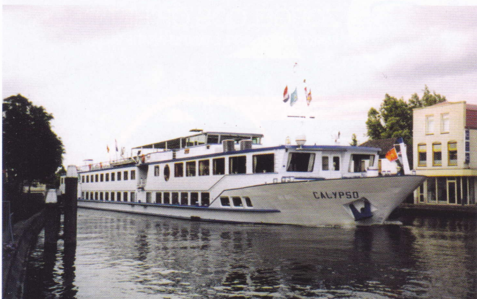
Ook nieuwere en meer eigentijdse passagiersschepen passeren op de Gouwe. In juni 2004 is dat de CALYPSO van E. van Velzen uit Maassluis, in 1977 bij Peters in Kampen gebouwd. Het 75,00 x 10,50 x 1,20 m grote schip heeft 46 luxe hutten aan boord. Het wordt aangedreven door 2 Deutz-motoren van 650 pk.
