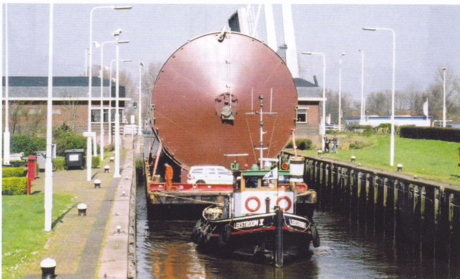
Nu we het toch over bijzondere transporten hebben: hier weer een voorbeeld dat op 27 maart 2007 passend en metend door de Julianasluis gaat. In dit geval voorop de sleepboot LEKSTROOMV van Lekstroom Transport BV (voorheen Eerland) uit Lekkerkerk. Gegevens van de boot: 20,02 x 5,41 x 1,26 m; 300 pk Bolnes; bouwjaar 1956 bij Van Bennekom in Sliedrecht.
