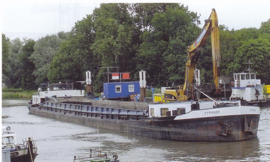
Ook de 'Rode Zwitser' laat zijn sporen na op de Gouwe. De TYPHOON (in 1940 bij Boel in Temse gebouwd als RONCO) van Rijnaarde BV uit Beuningen ligt hier in juli 2012 bij baggerwerk op het Gouwekanaal. Met 1239 ton en afmetingen van 80,00 x 9,50 x 2,56 m een groter schip dan die op de voorafgaande foto's. Totaal vermogen 2 x 371 pk Caterpillar en een boegschroef van 190 pk; dat maakt dus 932 pk.
