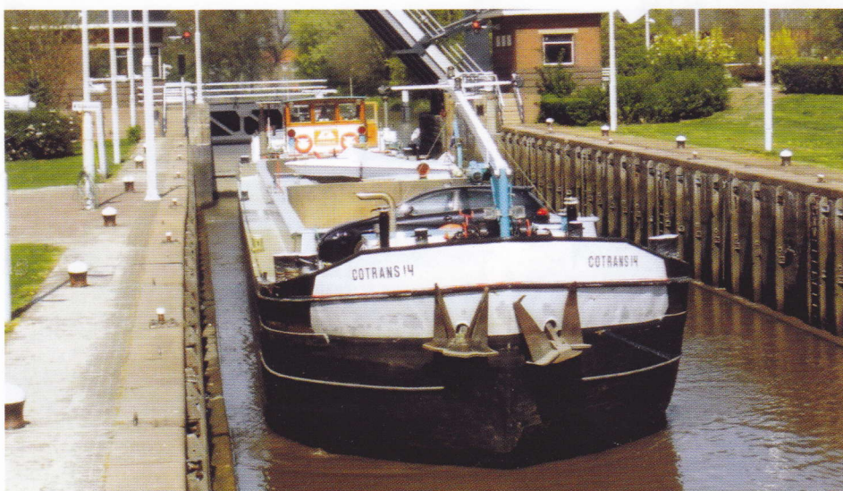
Nog een beunschip in de Julianasluis, in dit geval de COTRANS 14 met de afmetingen 70,00 x 7,30 x 2,60 m, 897 ton laadvermogen en 425 pk Cummins als motor. Het in 1960 bij de Haarlemsche Scheepsbouw van stapel gelopen schip heette eerst NATRA 9. Het schip voer al die jaren voor Cotrano uit Krimpen a/d IJssel, dat tegenwoordig onderdeel is van de Dekker Groep uit IJzendoorn.
