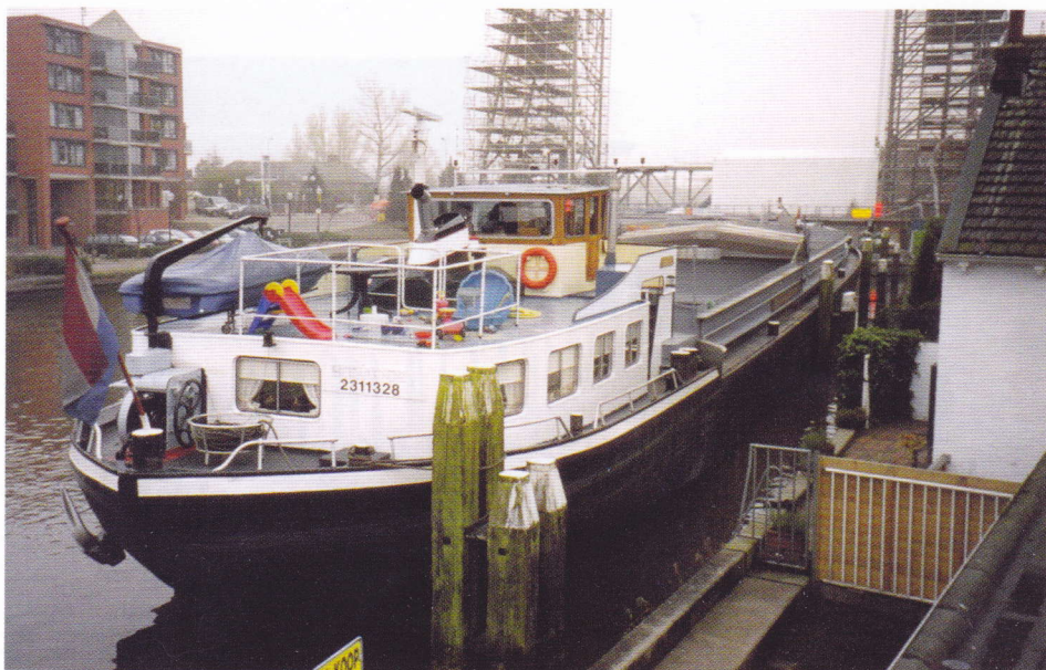
In november 2004 wordt er onderhoud gepleegd aan de Boskoopse brug. Schipper Van Hartingsveldt uit 's-Gravenpolder ligt met zijn BONAFIDE te wachten tot de brug omhoog gaat. Dit schip werd in 1943 bij Boel in Temse gebouwd. Ook hier weer gegevens: 55,03 x 7,25 x 2,64 m; 610 ton; 477 pk Caterpillar + 200 pk boegschroef.
