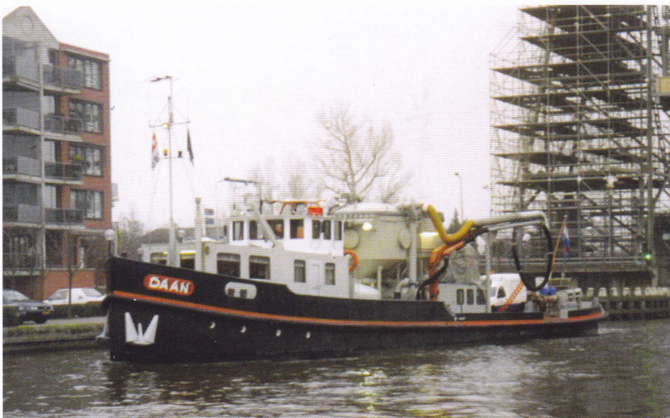
Een bijzondere verschijning is ook de DAAN (34,25 x 5,48; 1,77 m; 460 pk Caterpillar) die hier eind 2004 Boskoop passeert. De boot is van Enbo uit Koudekerk a/d Rijn en beschikt over een pneumatische installatie om poedervormige producten over te slaan, bijv. uit schepen. In 1929 als sleepboot HARMONIE IV gebouwd bij de Arnhemsche Scheepsbouw Mij. De DAAN werd in 2014 gesloopt bij Treffers B.V. in Haarlem.
