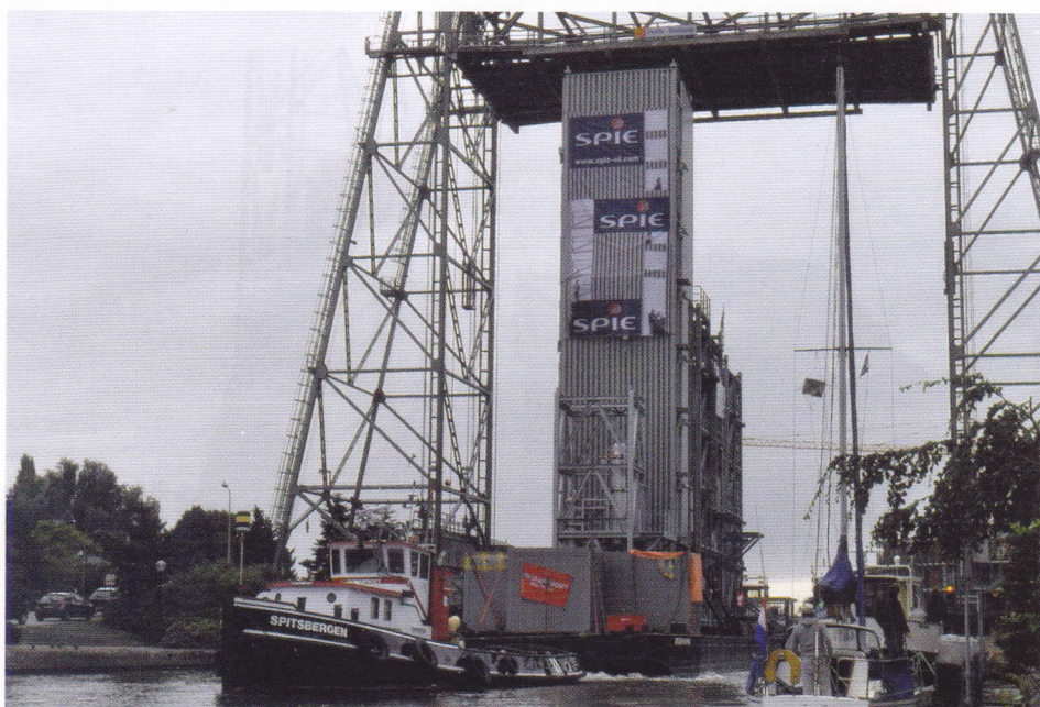
De 'hef' moet hier naar de hoogste positie om dit bijzondere transport door te laten. De foto werd gemaakt door Ank van der Bas op 7 september 2013. Voorop de SPITSBERGEN van Mammoet: 22,94 x 5,70 x 2,48 m; 653 pk Mitsubishi, in 1958 bij Bodewes in Millingen onder dezelfde naam gebouwd als havensleepboot voor Smit in Rotterdam.
