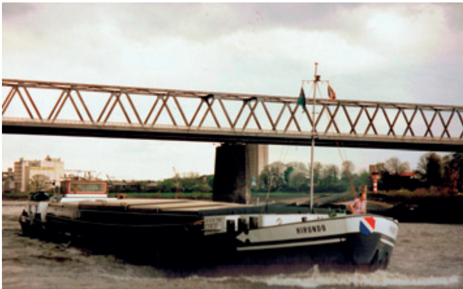
ms HIRUNDO van A. ten Haaf uit Lage Zwaluwe. Type motorschip. Eig. in 1980. Bouwjaar 1964 in Merelbeke bij Ganda. Afm. 55,00mx7,19mx2,60m, groot, 731 ton. EU nr. 2316137.
