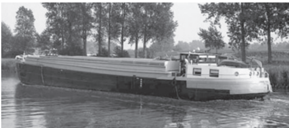
ms JAMAIS PENSÉ van Piet Dubbelman uit Lage Zwaluwe. Type motorspits. Eig. in 1957. Bouwjaar 1957 in Rupelmonde bij Chantier Naval de Rupelmonde. Afm. 8,87mx5,10mx2,41m, groot 328 ton. EU nr. 2309865.
