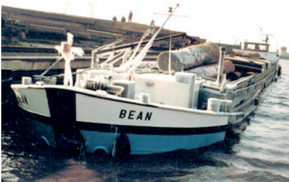
Een winters plaatje van het ms BEAN van Wim A.J. van Meel uit Lage Zwaluwe. Hier voor de wal in Kampen, geladen met boomstammen. Type motorschip. Bouwjaar 1963 in Antwerpen bij Meintjes. Afm. 62,12mx7,25mx2,61m, groot 783 ton. EU nr. 2006716.
