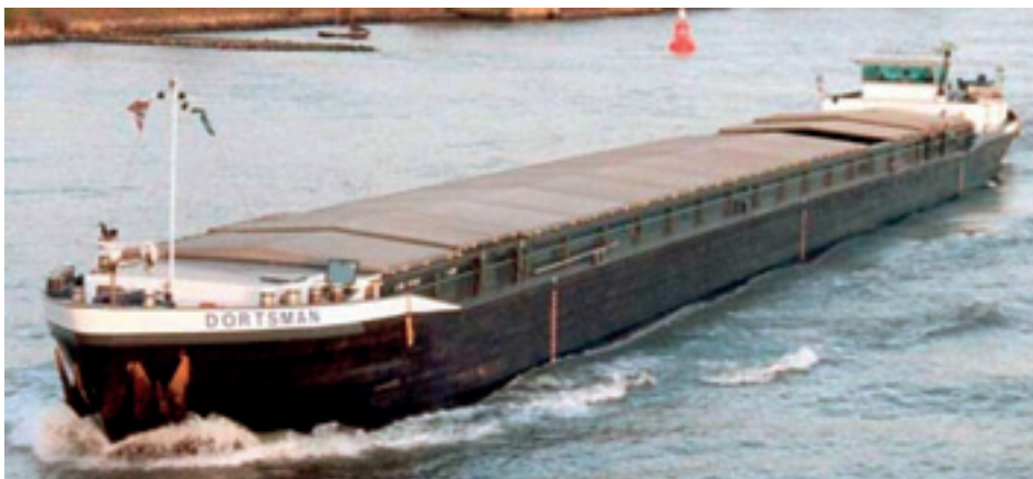
ms DORTSMAN van A. van Loon uit Drimmelen. Type motorschip. Eig. in 1996. Bouwjaar 1988 in Krimpen a/d IJssel bij Van der Giessen de Noord. Afm. 109,00mx10,52mx3,48m, groot 2794 ton. EU nr. 2318401.
