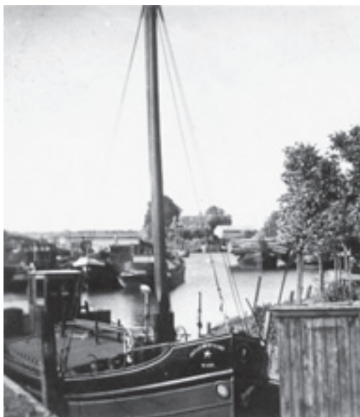
ms FRANCISCUS van Johannes en Simon van der Vaart uit Made in 1950 in de haven van Drimmelen. Bouwjaar 1924 in Roodevaart bij fa. Gebr. Paans, werf De Hoop der Drie Gebroeders. In het schip stond een motor van 30pk. Afm. 20,00mx4,57mx 1,53m, groot 60,458 ton. Brandmerk 244B Breda 1928.
