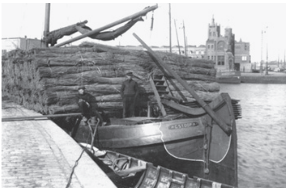
TWEE GEBROEDERS van Cornelis Stoop Dingemanszn. uit Made. Geladen met matriet. Een product uit De Biesbosch. Type stevenaak. Eig. in 1914. Bouwjaar 1903 in Raamsdonksveer bij Van Suijlekom. Afm. 19,17mx4,57m, groot 72,852 ton. In 1907 verlengd: groot 86,897 ton. Brandmerk 293B sBosch 1914. (Het vermelde brandmerk is onjuist) Later 263B sBosch 1957.
