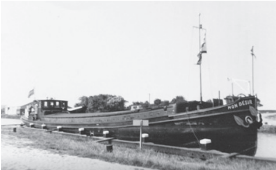
ms MON DESIR van Willem van Leeuwen uit Lage Zwaluwe. Type motorschip, 87pk MWM. Bouwjaar 1922 in Gouderak bij fa. H. van Vlaardingen. Afm. 28,15mx5,27m, groot 108,391 ton. Later verlengd en 160 ton. Brandmerk 3649B Rott 1928.
