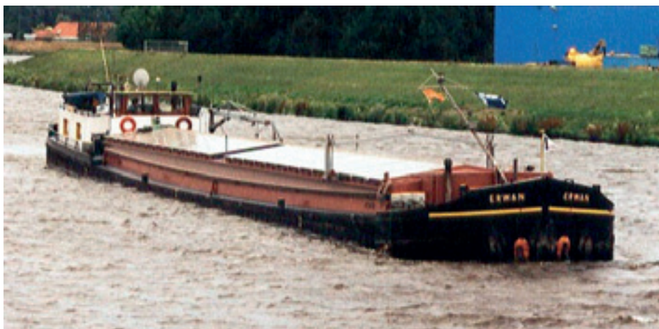
2001 ms ERWAN van Wijnand van Gils Azn. uit Made geladen met cement op het Wilhelminakanaal beneden de sluis. Type motorspits, 300pk Volvo Penta. Eig. in 1978. Bouwjaar 1966 in Tielrode bij De Durme. Afn. 47,00mx5,10mx2,60m, groot 463 ton. Brandmerk 14018B Rottt 1974.
