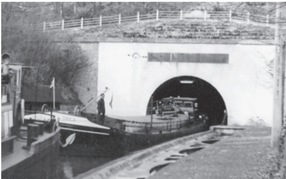
ms DINCA van P. Thijssen uit Made komt uit de tunnel in Frankrijk. Type motorspits. Eig. in 1961. Bouwjaar 1943 In Boom bij L. de Winter. Afm. 38,65mx5,08mx2,37m, groot 340,232 ton. Brandmerk 600B Breda 1961.
