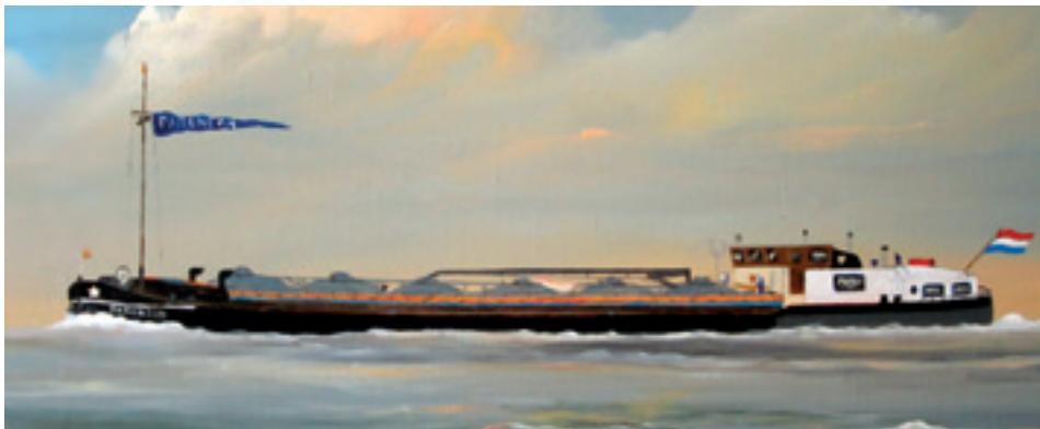
1995 ms PARANGON (schilderij) van J. van der Veeke jr. uit Made, later Geertruidenberg. Type motortankspits. Het schip is begin jaren tachtig omgebouwd tot cementtanker. Eig. in 1974. Bouwjaar 1945 in Schelle bij Jacobs. Afm. 38,87mx5,04mx2,38m, groot 338 ton. EU nr. 2310536.
