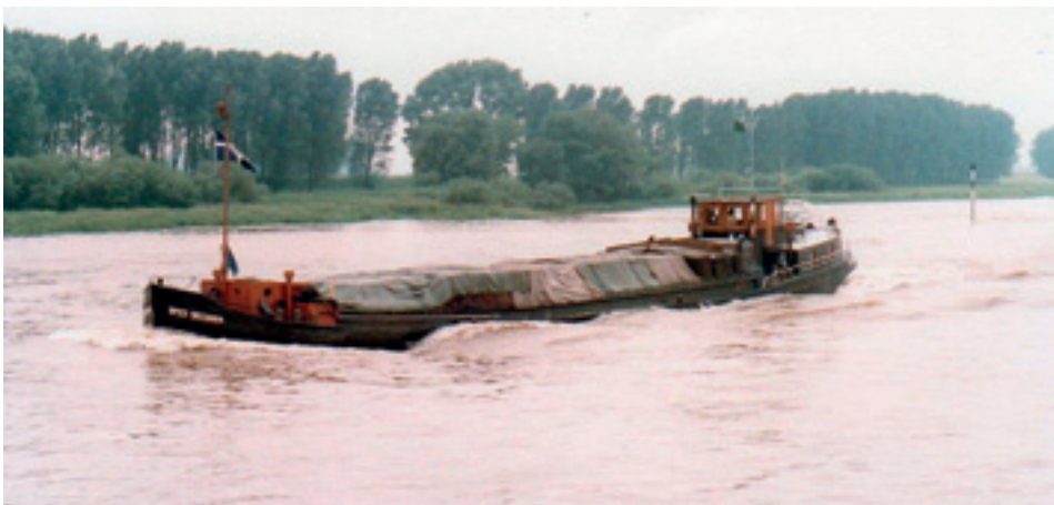
ms SPES SECUNDA van W.H. van Suijlekom uit Drimmelen. Type motorschip. Eig. in 1983. Bouwjaar 1926 in Hendrik Ido Ambacht bij Jonker & Stans. Afm. 41,95mx6,14mx2,17m, groot 318 ton. De foto is met vroegere eigenaar Wim van der Klippe uit Bruinisse. EU nr. 2301751.
