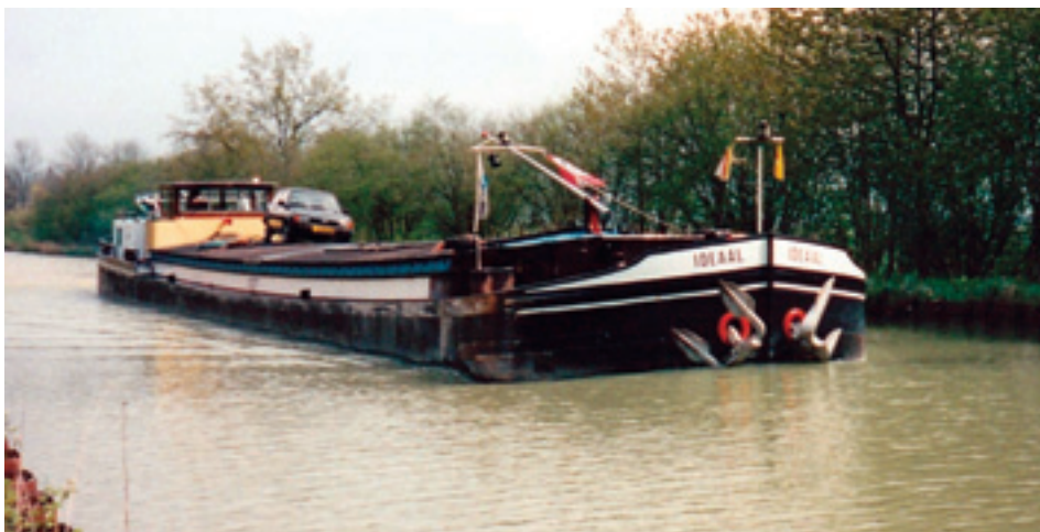
ms IDEAL van W.J.M de Wijs uit Made, varend in Frankrijk. Type motorspits. Eig. 1986. Bouwjaar 1962 in Boom bij René de Winter. Afm. 38,80mx5,07mx2,52m, groot 357 ton. ENI nr. 02311277.
