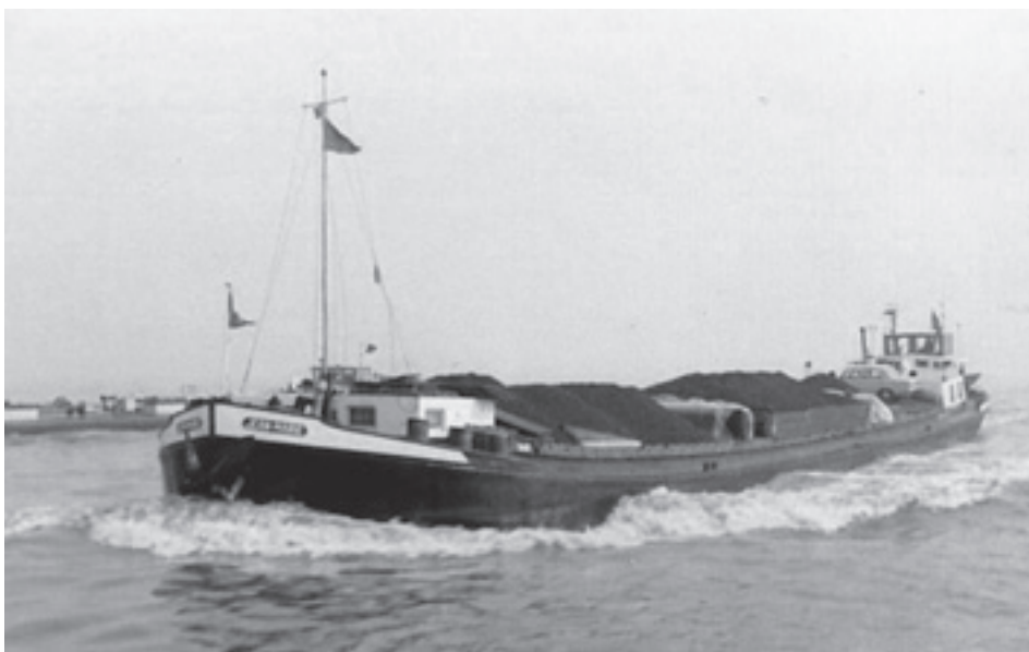
ms Jean-Marie van J. Broeken uit Made. Type motorschip. Bouwjaar 1905 in Alphen a/d Rijn. Afm. 53,00mx7,40m, groot 602 ton.
