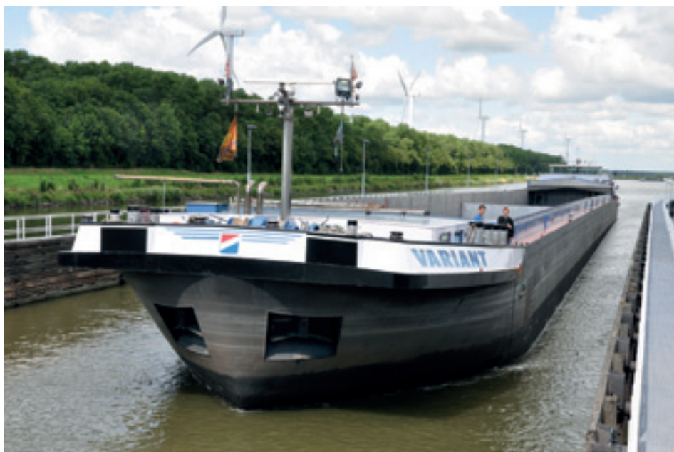
ms VARIANT van Leendert G. ten Haaf uit Lage Zwaluwe vaart de Volkeraksluis binnen. Type motorschip. Leen heeft dit schip in 2001 in Jingjiang bij Jingjiang Traffic laten bouwen. Afm. 134,96mx11,45mx3,32m, groot 3954 ton. EU nr. 2324791.
