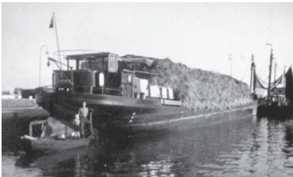
1948 het sleepschip MARIE van A.C. de Bot uit Made. Geladen met vlas in de haven van Urk. Het bootje, een opdrukker, ligt aan het achterschip. Bouwjaar 1910 in Gouwsluis bij D. Boot, bouwnummer 413. Afm. 43,70x6,58mx2,12m, groot 403 ton. Brandmerk 330B Breda 1929.
