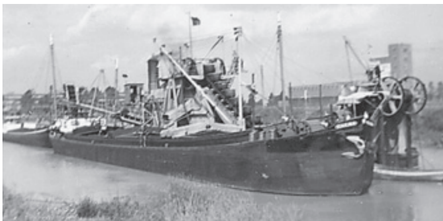
ms MARINA van Cor van Gils uit Made. Grint laden in de omgeving van Maasbracht voor Breda. Type motorschip, 133pk MWM. Bouwjaar 1912 in Bolnes bij Schram. Afm. 50,00mx6,60mx2,09m. groot 509 ton. Brandmerk 25B Tiel 1927.
