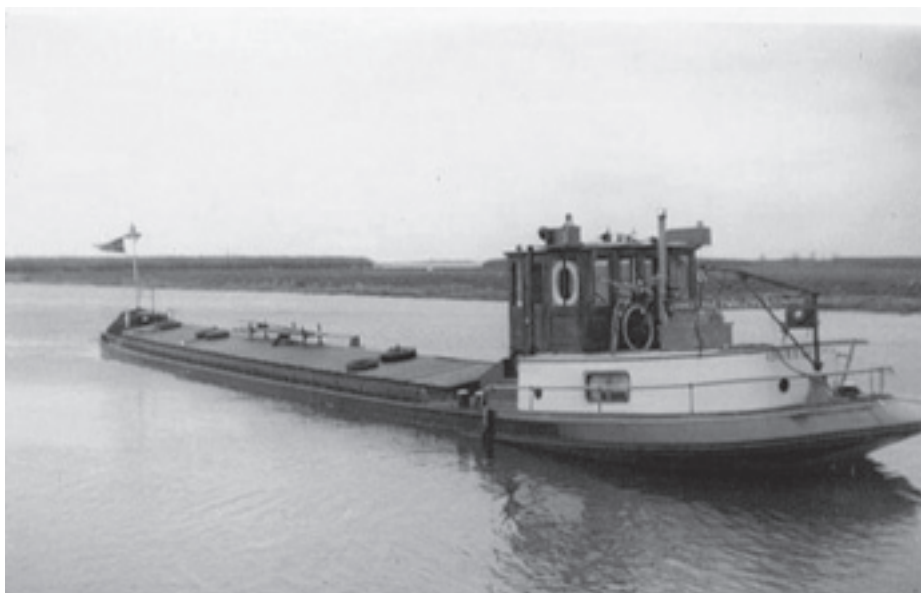
JANNY van Willem ten Haaf uit Lage Zwaluwe. Type motorschip. Bouwjaar 1928 in Britil bij Barkmeijer en Koning. Afm. 23,03mx4,22m, groot 75,255 ton. In 1956 verlengd naar 29,06mx4,27mx1,46m, groot 102,966 ton. Brandmerk 1010B Dord 1928.
