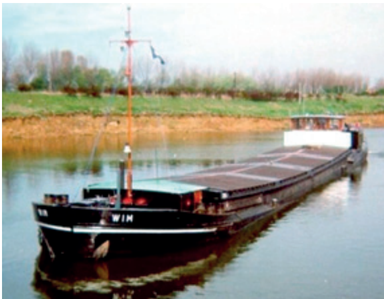
ms WIM van C.A. van der Sluijs uit Drimmelen. Type motorschip, 300pk Brons. Cees heeft dit schip laten bouwen in 1961 in Roodevaart bij de Gebr. Geleijns. Afm. 50,00mx6,60mx2,42m, groot 500 ton. In 1979 verlengd en verdiept. Afm. 62,00mx6,60mx2,62m, groot 700 ton. In 1981 wordt zoon Simon eigenaar van het schip. EU nr. 2310743.
