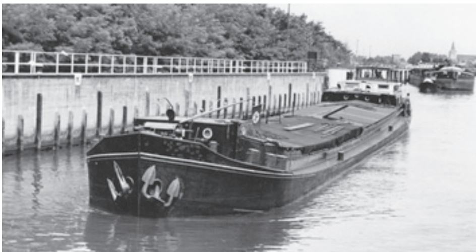
ms ELWI van Elias Biemans uit Made. Type motorschip. (gebouwd als sleepschip) Eig. in 1950. Bouwjaar 1915 in Leiderdorp bij de Gebr. Boot. Afm. 49,97mx6,60mx2,42m, groot 527,613 ton. Brandmerk 5919B Rott 1937.
