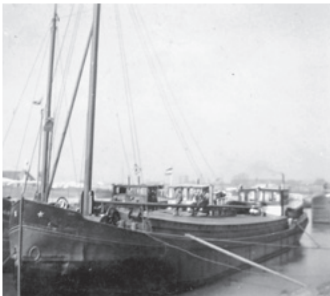
ms ENERGIE van P. en H. Norbart uit Made. Type motorschip, 45pk. Op dit schip heeft J.de Jongh uit Made jaren als schipper gevaren. Bouwjaar 1922 in Waspik bij P.A. Ruijtenberg. Afm. 27,50mx5,06mx1,71m. Groot 118,641 ton. Brandmerk 321B Dord 1927.
