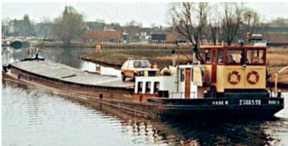
ms SAN ANTONIO van M.J. Halters uit Made. Type motorschip. Eig. in 1977. Bouwjaar 1923 in Alblasterdam bij J. Smit. Afm. 50,00mx6,59mx2,27m, groot 501 ton. EU nr. 2300598.
