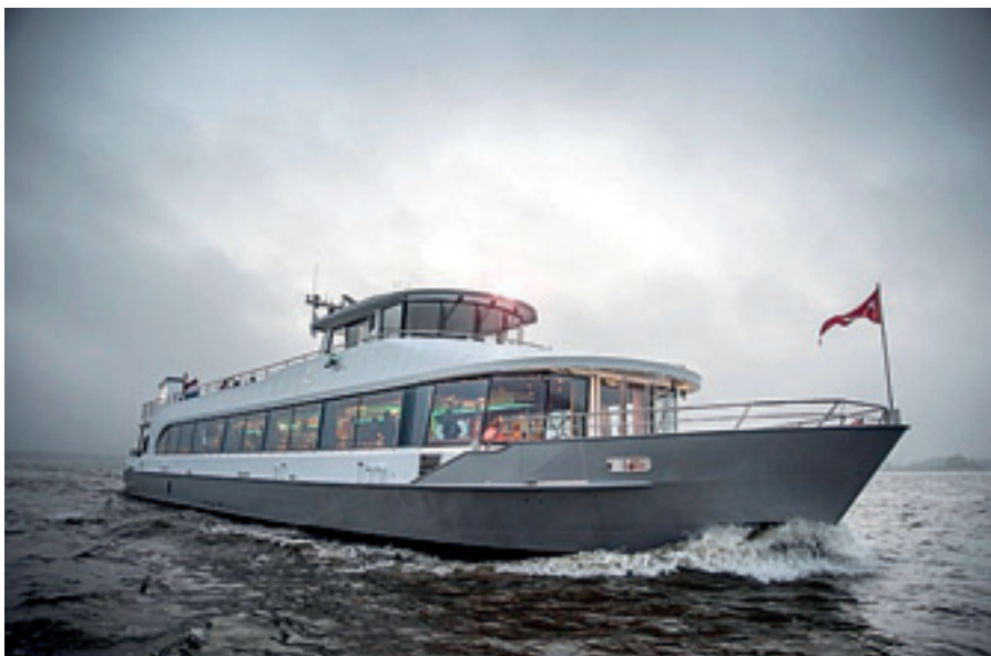
mps Z8 van Zilvermeeuw Rondvaartbedrijf uit Drimmelen. Type passagiersschip; het schip wordt elektrisch voortbewogen. Het rondvaartbedrijf heeft het schip in 2016 in Moerdijk bij Made Scheepswerf BV laten bouwen. Afm. 38,40mx6,90mx1,25m. ENI nr. 02336736.
