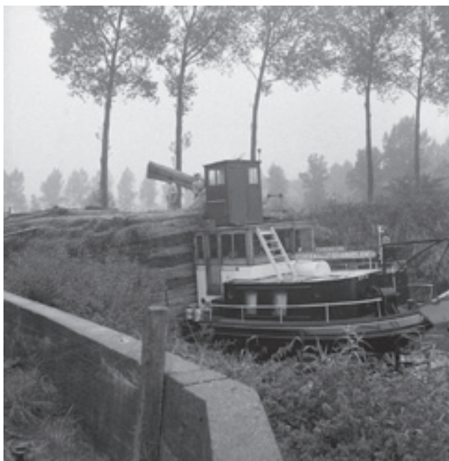
De luxe motor ZORG EN VLIJT van Cees Schuller uit Drimmelen is bezig met het lossen van matriet in Waasmunster(B). Cees staat bij de stuurhut op de last. Bouwjaar 1917 in Raamsdonksveer. Motor 35pk gloei-kop. Afm. 27,15mx5,08m, groot 102,164 ton. Brandmerk 170B Breda 1928.
