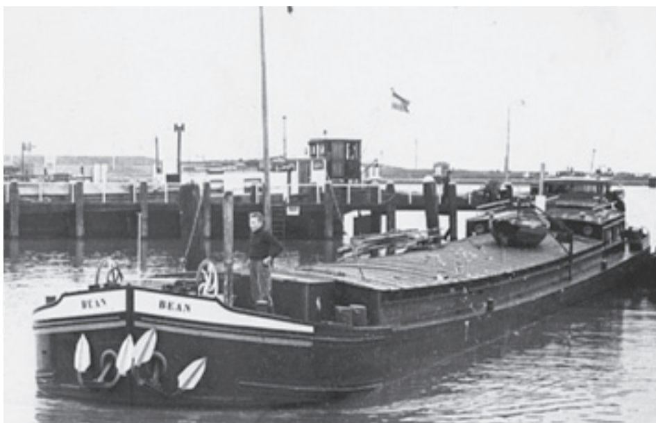
1956 ms BEAN van Bernardus van Meel uit Made vaart de kleine sluis in Hansweert in. Voorop staat zoon Wim. Type motorspits. Eig. in 1954. Bouwjaar 1950 in Boom bij Gebr. De Wachter. Afm. 38,80mx5,05mx2,37m, groot 354 ton.
