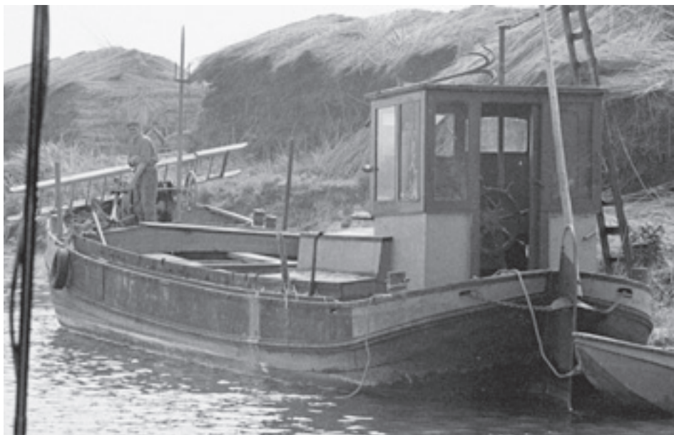
DE HOOP van C.H. Schuller en W.J. Schuller uit Drimmelen. Klaar om riet te laden in de Biesbosch. Type motoraak van staal. Bouwjaar 1900 bij Gebr. van Limborgh in Lekkerkerk. Afm. 14,85mx3,48m, groot 29,399 ton. Motor 22pk Kromhout gloeikop nr. 3981-135/50. Brandmerk 431B Rott 1926.
