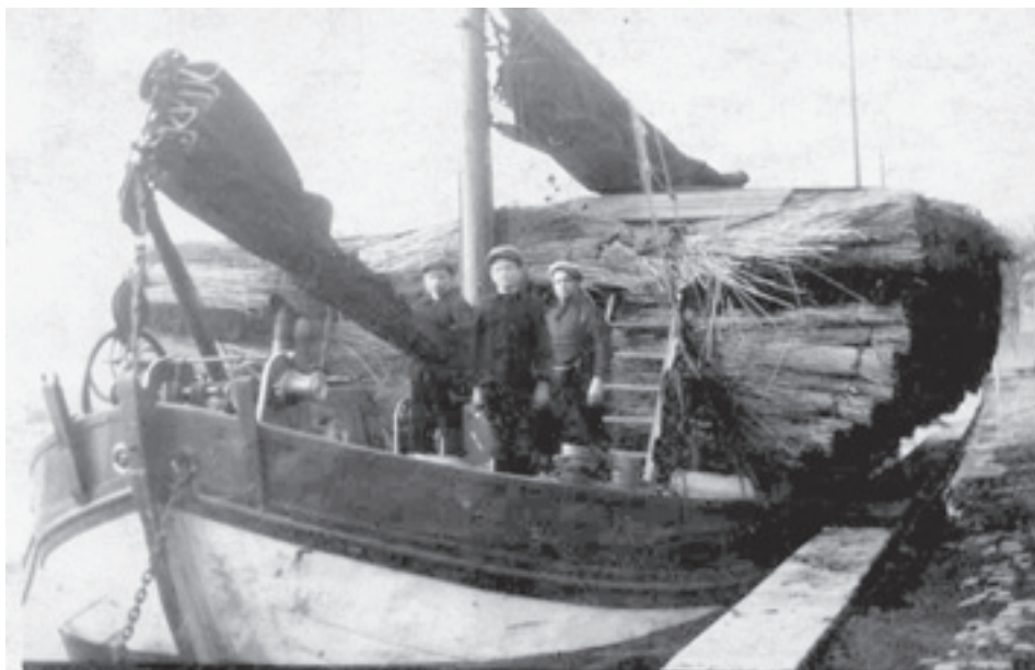
1926 De stevenaak KOOPHANDEL van Wijnand van Gils uit Made, met dekriet voor de wal in Arnhem. V.l.n.r. de zonen Cor en Dries en vader Wijnand. Eig. ca 1922. Bouwjaar 1914 in Waspik. Afm. 20,75m x 4,75m, groot 77,180 ton. Brandmerk 231B Breda 1928.
