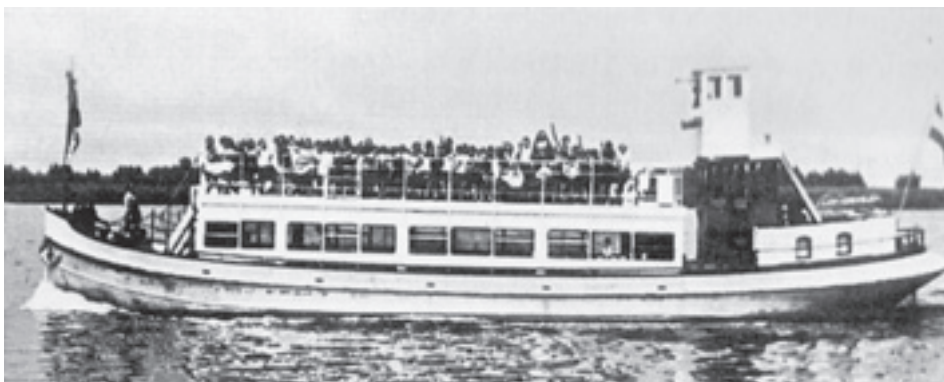
Ca. 1964. Rederij 'Zilvermeeuw' neemt passagiers aan boord van DE HOOP OP WELVAART van C. Schuller uit Drimmelen. Type motorschip, 30pk bij de bouw. Bouwjaar 1925 in Roodevaart bij de Gebr. Paans. Afm. 23,06mx4,68m,groot 75,746 ton. Brandmerk 6824B Rott 1925, later 540B Breda 1956.
