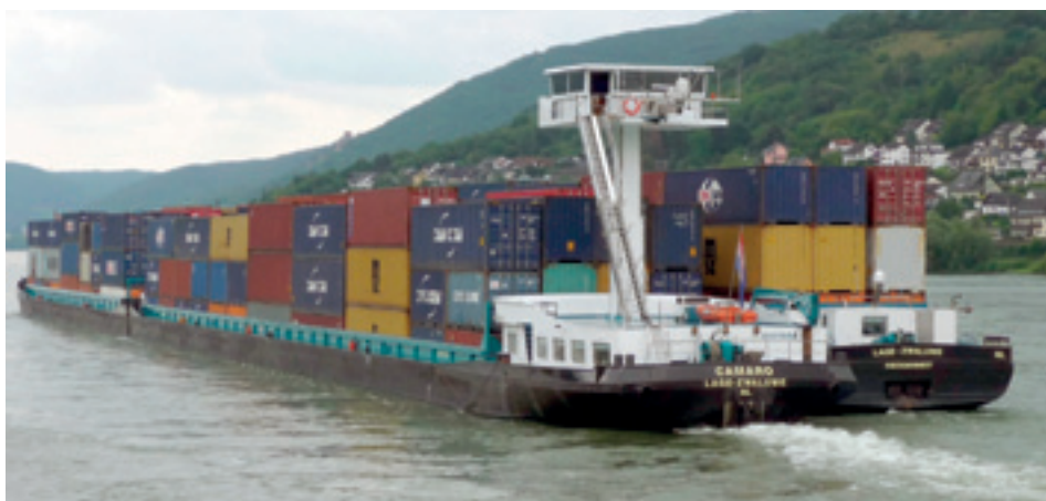
ms CAMARO van Camaro BV Scheepvaartbedrijf uit Lage Zwaluwe op de Rijn met een duwbak opzij geladen met containers. Type motorduwschip. Eig. 1999. Bouwjaar 1985 in Papendrecht bij Slob. Afm. 109,97mx11,40mx3,00m, groot 2648 ton. EU nr. 2317558.
