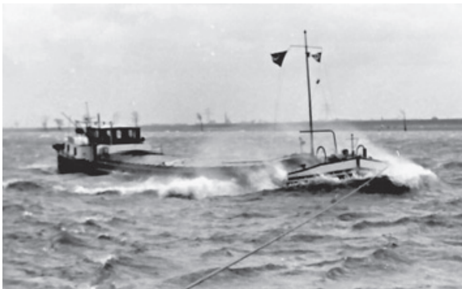
ca. 1970 ms ANRIE van Julius de Wijs uit Made. Type motorspits. Eig. in 1965. Bouwjaar 1930 in Temse bij J. Boel & Zn. Afm. 38,50mx5,05m, groot 353 ton. Brandmerk 564B Breda 1959.
