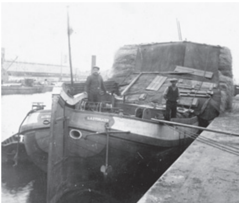
Ca. 1920 de klipperaak LASTDRAGER geladen met vlas van Cees v.d. Veeken (bij de helmstok) uit Made. Eig. op 28 juni 1912. Bouwjaar 1897 in Raamsdonksveer. Afm. 20,50mx4,88m, groot 84,160 ton. Brandmerk 193B sBosch 1936.
