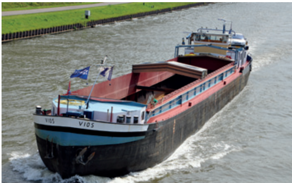
Het ms VIOS van M.L.P.C. van der Pluijm uit Made gefotografeerd bij Nieuwegein op het Lekkanaal. Type motorschip. Eig. in 1990. Bouwjaar 1954 in Duisburg bij de Meidricher Schiffswerft. Afm. 57,35mx7,03mx2,67m, groot 728 ton. ENI nr. 02315427.
