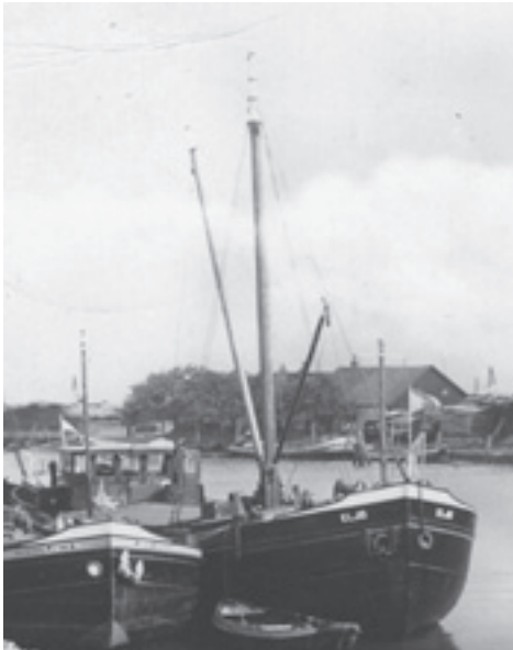
1939 ms ELJO van J.M. Schuller uit Drimmelen hier in de haven. Type motorschip. Eigenaar 1936. Bouwjaar 1927 in Groningen bij J. Th. Wilmlink & Co. Afm. 36,50mx5,10mx1,98m, groot 217 ton. EU nr. 2302684.
