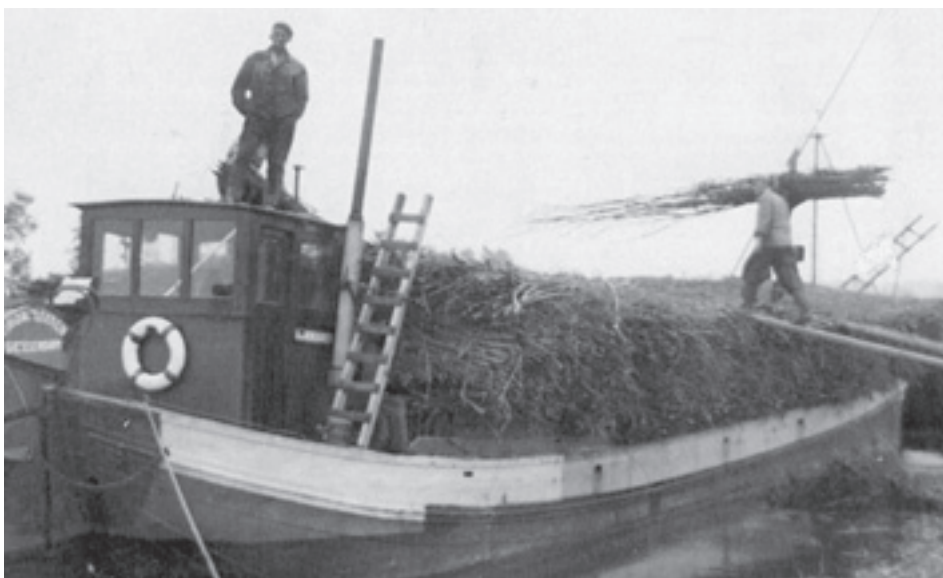
DE TIJD ZAL 'T LEREN van Arie van Wijngaarden uit Giessendam, wordt geladen met rijshout. Het schip is later verkocht aan A.B. Vos uit Lage Zwaluwe en krijgt dan de naam WILJAN. Type boeieraak met motor 30pk Kromhout. Bouwjaar 1910 in Waspik bij De Graaf. Afm. 20,64x4,48m, groot 75,583 ton. Brandmerk 1223B Dord 1928.
