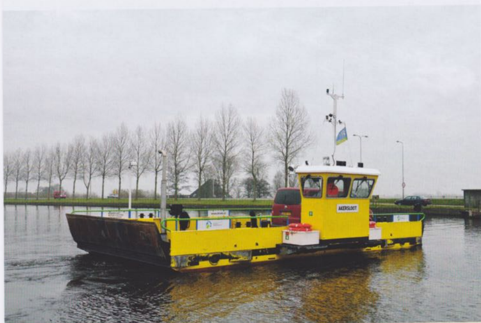
In 2010 is er een nieuwe veerpont in dienst gekomen. De motorveerpont AKERSLOOT werd gebouwd bij Damen Shipyard in Hardinxveld. De afmetingen zijn: 14,95 x 6 m met een 200 pk Deutz motor.
