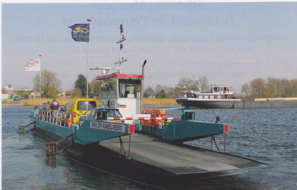
De veerpont AALST II werd in 2011 gebouwd als VEERKRACHT voor de veerdienst Gouderak-Moordrecht. In 2013 werd zij aangekocht als vervanger voor de oude pont AALST I. De afmetingen zijn: 27,81 x 5,18 x 0,85 m, met 2 x 137 pk John Deere dieselmotor.
