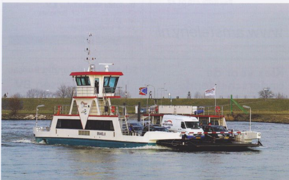
De Brakel II was in 2009 de eerste "groene" veerpont in Nederland en wordt diesel - elektrisch aangedreven. De drie generatoren aan boord geven vermogen naar vraag (afzonderlijk of in combinatie).
