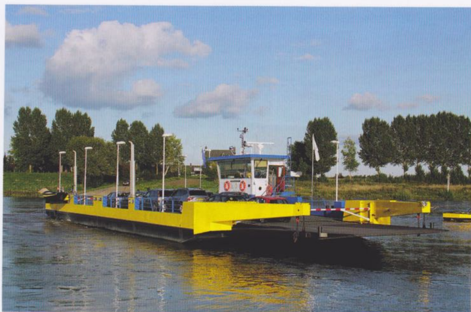
Vanaf 2010 vaart er een nieuwe WILLEM tussen Doornenburg en Pannerden. Deze gierpont werd gebouwd bij Vahali in Gendt. De afmetingen zijn: 46,00 x 12,80 x 0,80 m, met 2 x Volvo Penta D5, 140 pk.
