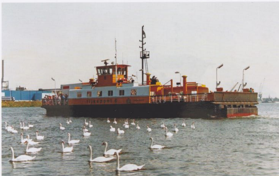
De RIJKSPONT 6 werd in 1933 gebouwd als stoomveerpont. Later werden deze ponten gemotoriseerd met een 425 pk Stork-dieselmotor. In 2007 werden de RijksPonten ondergebracht bij het Gemeentevervoerbedrijf Amsterdam (exploitatie Connexxion). Sinds 01-07-2013 zijn zij geheel overgegaan naar het Gemeentevervoerbedrijf Amsterdam in Amsterdam en varen zij onder de naam PONT met een nummer.
