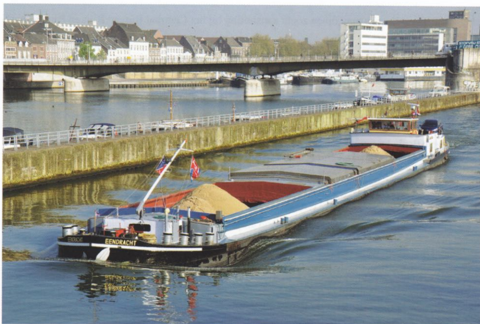
De EENDRACHT (02303956) is het voormalige sleepschip ANTEMA van A.L. Bakx uit Waspik - lxbxd: 66,95x8,20x2,50 – 957 ton. Bouwjaar 1929 werf Smit, Foxhol.
