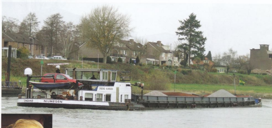
ONDINE (02006411) Jan Suijkerbuijk (plaatsvervangend voorzitter RKSb) - lxbxd: 66,94x8,20x2,61 – 996 ton / 640 pk Caterpillar. Bouwjaar 1962 Arminiuswerf, Bodenwerder. Gebouwd als HERBRUM van Westfälische Transport AG in Dortmund
