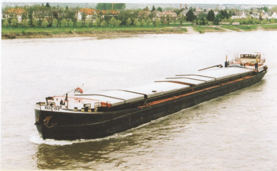
NICOR (2100373) J.B.N Snellens in Rotterdam – lxbxd: 95,16x11,34x3,20- 2381 ton / 2 x 800 pk Deutz. Bouwjaar 1926 werf Van der Schuijt, Papendrecht. Gebouwd als sls ST. JOSEPH van C. Poppelier in Waspik. In 1964 omgebouwd tot mvs.
