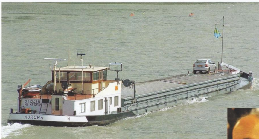
AURORA (02312496) Jan Buil (bestuurslid RKSb) – lxbxd: 64,99x7,03x2,32 – 699 ton / 548 pk Caterpillar. Bouwjaar 1955 Ruhrorter Schiffswerft, Duisburg. Gebouwd als OSNABRÜCK van Gebr. Hardach in Bad Essen.
