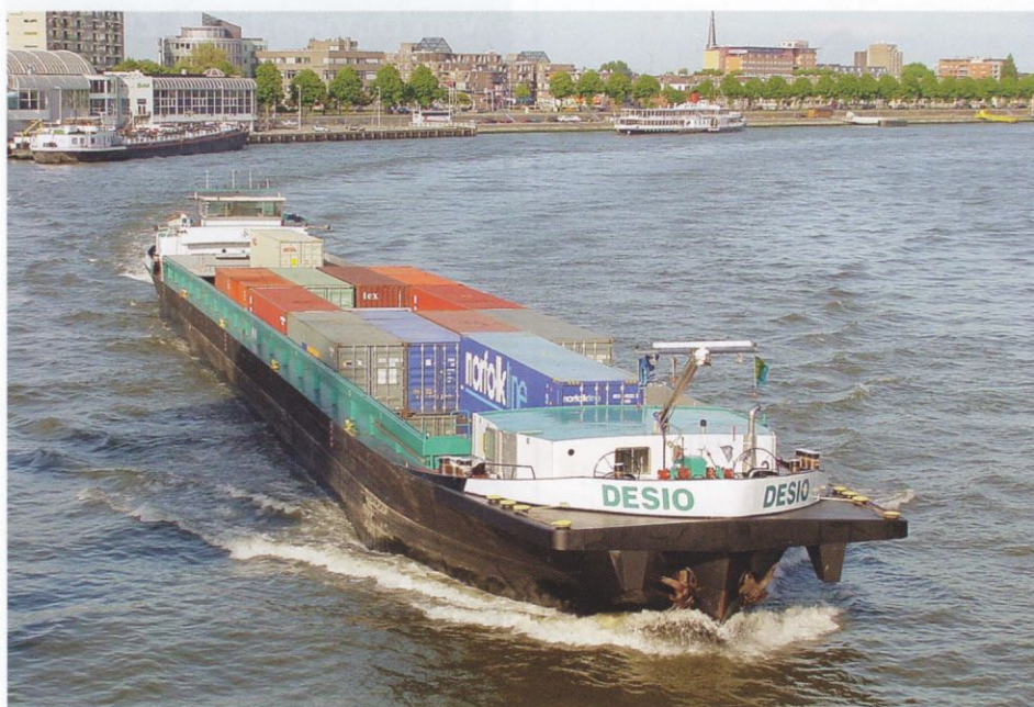
DESIO (2316609) W.G.A. Suijkerbuijk in Dongen – lxbxd: 109,88x11,40x3,57 – 2999 ton / 2 x 1298 Caterpillar. Bouwjaar 1958 werf H.H. Bodewes, Millingen. Gebouwd als mts MERGUS van Tankschiff AG in Basel.
