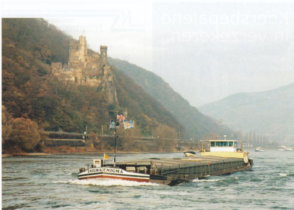
ENIGMA (2305633) van Toor & de Geer in Capelle a/d IJssel – lxbxd: 79,84x9,47x2,59 – 1257 ton / 2 x 450 pk Caterpillar. Bouwjaar 1935 werf A. Vuijk & Zn., Capelle a/d IJssel. Gebouwd als sls MARIE IV van Gebr. J.W. Rademakers in Roosendaal. In 1973 omgebouwd tot mvs.
