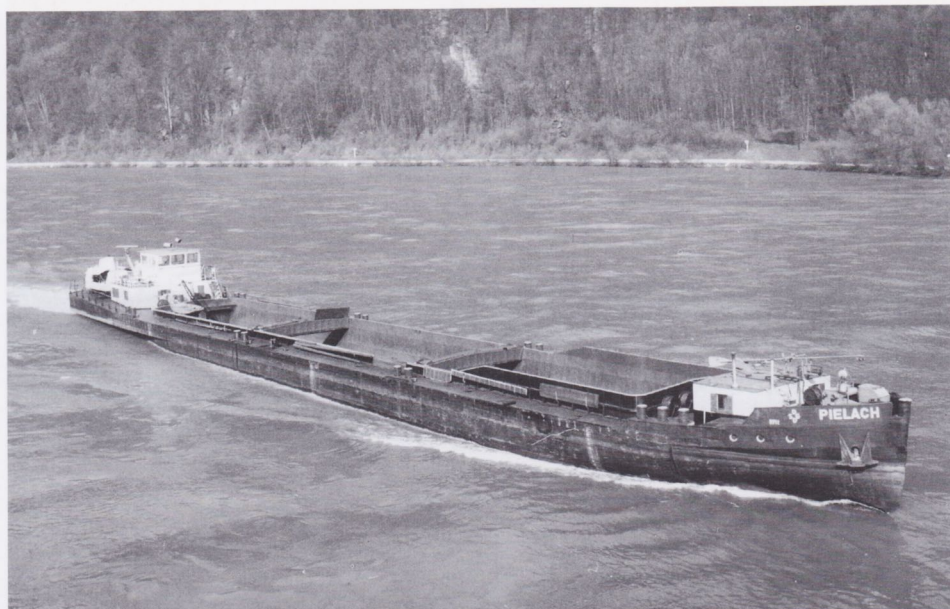
In 1974 liet de DDSG vier sleepschepen ombouwen tot motorvrachtschip door er twee Schottelmotoren van ieder 436 pk op te zetten. Uit het sleepschip 10102 ontstond zo de PIELACH. De lengte was 76 m, de breedte 9,50 m, het laadvermogen was 971 ton. Op 18 februari 1997 vertrok het schip voor haar laatste reis uit Linz.
