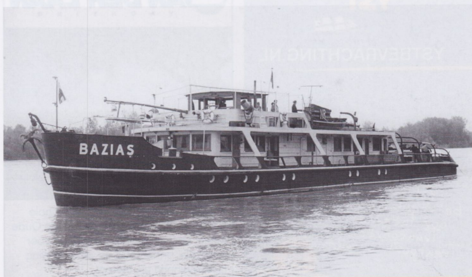
De Roemeense NR heeft circa 65 motorsleepboten in de vaart gehad. De BAZIAS was er één van. De boot ging in 1961 als ELENA PAVEL te water in Oltenita. Vier jaren kwam de naamsverandering al. De boot was ongeveer 48 m lang en 7,20 m breed. Het exacte motorvermogen is onbekend, maar lag bij dergelijke boten tussen 1000 en 1400 pk.
