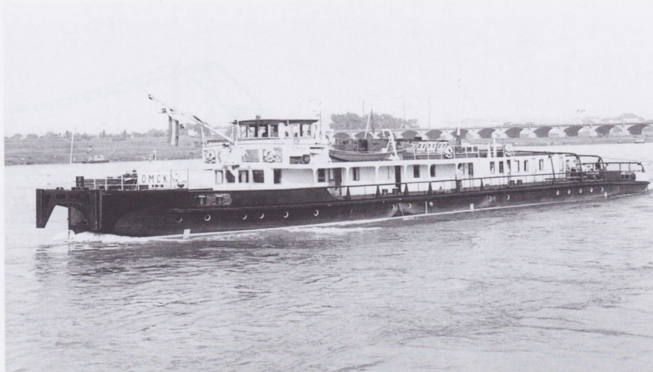
Ook sleep-duwboot OMSK kwam na de oorlog naar de Sovjets. De boot werd in 1929 in Linz gebouwd als AMSTERDAM voor de Comos, was 57,10 bij 8,00 m groot en 3 x 400 pk sterk. In 1940 ging de boot ARNULF heten (nog steeds bij de Comos). In 1948 werd het de OMSK (bij de SDGP) en later vond de ombouw plaats naar sleep-duwboot.
