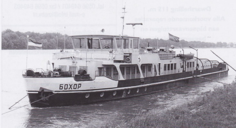
De motorsleepboot BOHOR van de Joegoslavische JRB werd in 1964 gebouwd en vormde samen met de BjELASICA en de BUKOVIC een serie van drie zusterboten. De bouwwerf is onbekend. Ze hadden een vermogen van 2 x 450 pk, waren 49,22 m lang en 8,40 m breed.
