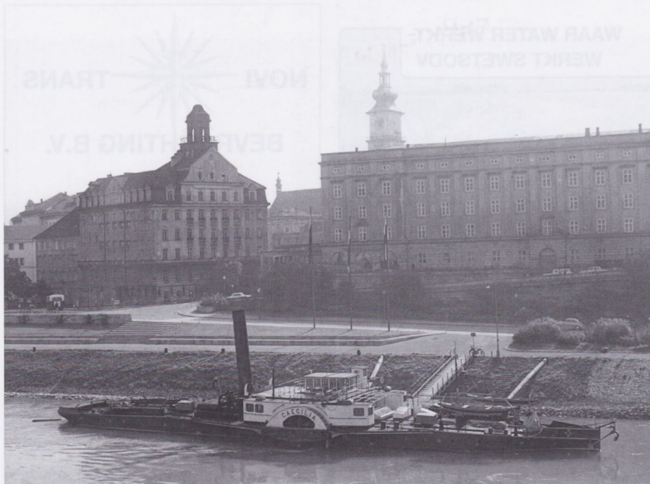
De 'Einkamminer' CAECILIA van de DDSG werd onder dezelfde naam gebouwd voor de SDG in 1914 bij Uebigau in Deggendorf. In 1937 ging de boot naar de DDSG en in 1962 is ze gesloopt. De boot was 52,10 m lang en 12,20 m breed (zonder raderkasten 6,53 m) en was 350 pk sterk.
