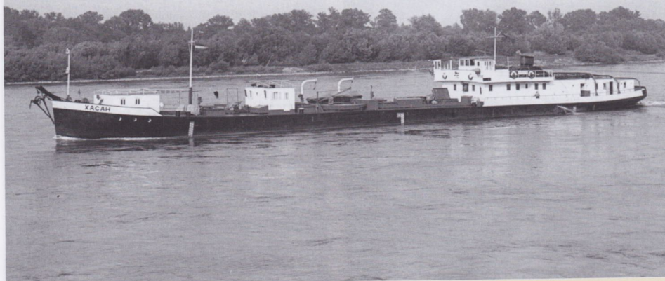
De CHASAN van de Sovjetrederij SDGP kon schepen slepen, maar tegelijk ook zelf 816 ton lading meenemen. Het tankschip werd in 1941 als JOSEF JULIUS WALLNER in Deggendorf gebouwd, kreeg 2 x 420 pk mee en had de afmetingen 70,90 bij 9,03 m. Vanaf 1945 verkeerde het schip bij de Sovjets als CHASAN.
