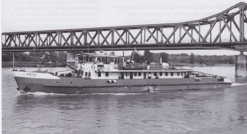
De PÉCS van de Hongaarse MHRT (Mahart) werd in 1958 gebouwd op de Obuda-werf met de afmetingen 47,93 (46,26) bij 7,20 m en 2 x 400 pk. Evenals de zusterboten PAKS en MISKOLC werd deze in 1968 omgebouwd tot duwboot met de afmetingen 48,29 (47,47) bij 9,83 m en toen voorzien van 2 x 600 pk (volgens andere bronnen 2 x 1000 pk).
