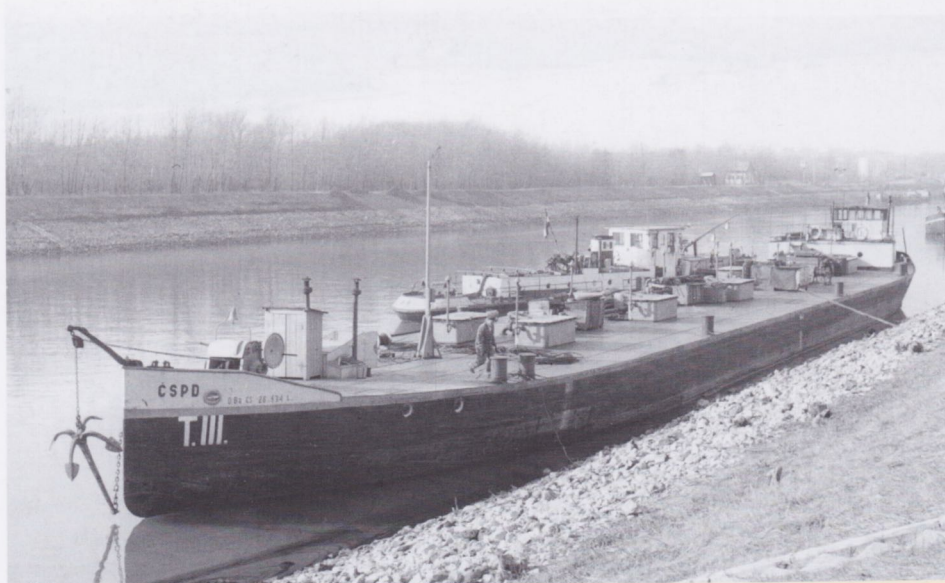
Voorbeeld van een tanksleepschip op de Donau, in dit geval de T III van de Tsjechoslowaakse CSPD uit Bratislava. Op de Donau waren naast veel sleepschepen voor droge lading ook relatief veel tanksleepschepen in bedrijf bij verschillende rederijen. Verdere gegevens van het sleepschip op de foto zijn niet bekend.
