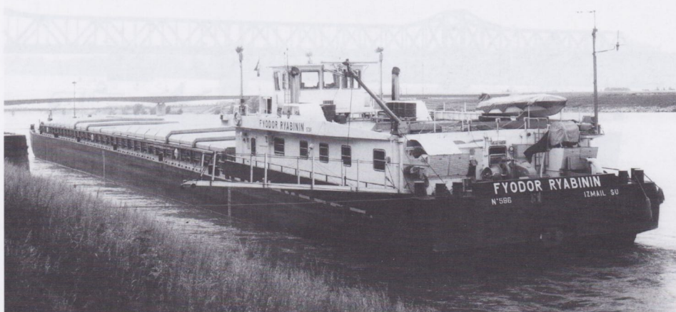
Het duwmotorvrachtschip FYODOR RYABININ werd in 1981 afgeleverd door de scheepswerf Linz. Tussen 1980 en 1985 bracht de Sovjetrederij SDP 20 van deze schepen in de vaart. Nu varen ze bij de Oekraïner UDP. Ze zijn 95 x 11,03 m bij een tonnage van ca. 1900. Met hun 2100 pk nemen ze op de Beneden-Donau tot 5 duwbakken mee.
