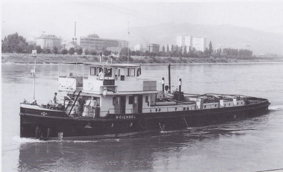
De motorsleepboot WEICHSEL van de DDSG heette eerst ALBERT THIELECKE en werd in 1937 bij Wiemann in Brandenburg gebouwd voor de SDC-BL. De boot was 38,04 m lang en 6,92 m breed en beschikte over twee Deutzmotoren van ieder 270 pk. De boot werd in 1968 verkocht en heette daarna ELSBETH PFAFFINGER.
