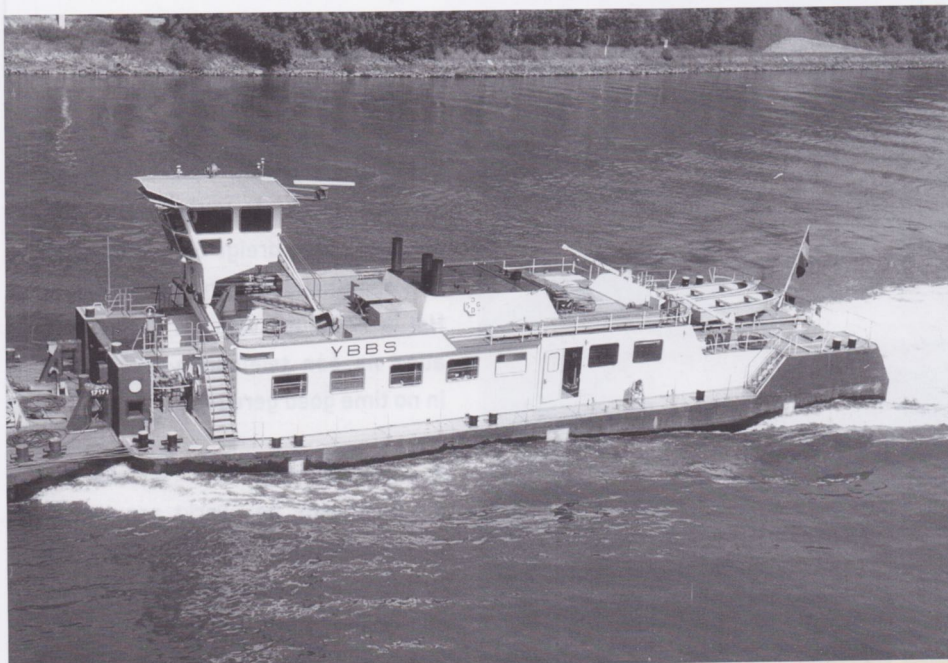
De YBBS werd in 1975 in Linz voor de DDSG gebouwd (31,96 x 11,38 x 1,90 m). Zusterboot is de MELK. Oorspronkelijk beschikten de boten over drie Schottel-roerpropellers (aangedreven door 2 x 900 en 1 x 750 pk MWM). In 2003 werden die vervangen door 3 motoren van 1200 pk, waarbij de boten 3 m werden verlengd.
