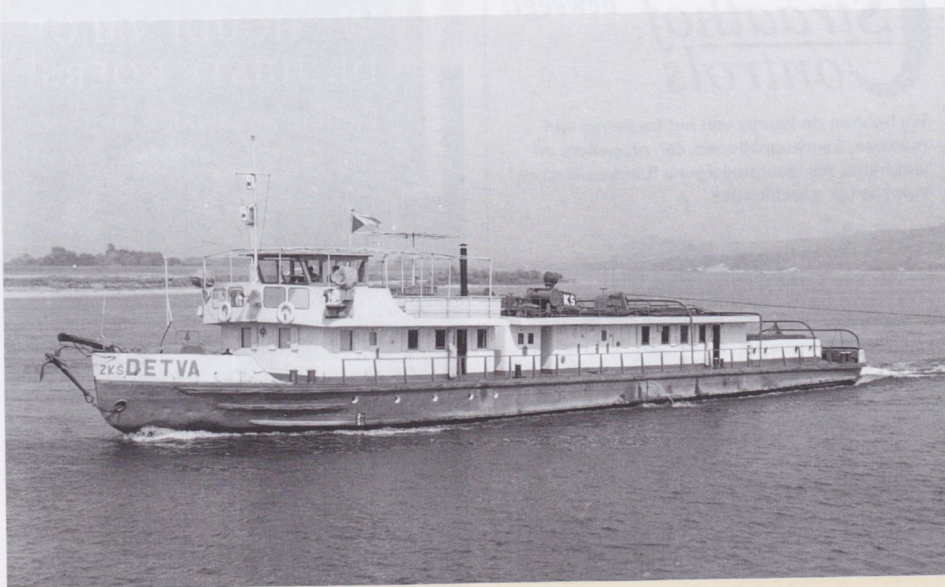
De Slowaakse baggermaatschappij ZKS beschikte ondermeer over de motorsleepboot DETVA. Die werd in 1960 op de Slowaakse werf Komárno gebouwd en was 2 x 175 pk sterk. Verdere gegevens ontbreken.
