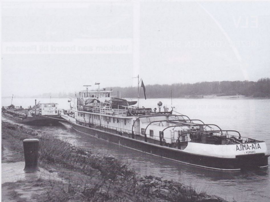
De sleep-duwboot ALMA ATA van de Sovjet-SDGP ging in 1964 in Budapest als één van de eerste exemplaren van een grote serie van 56 identieke boten (type 4151) te water, waarvan er 52 voor de SDGP bestemd waren. Deze boten waren 57,61 m lang en 8,60 m breed en beschikten over 2 x 1000 pk.
