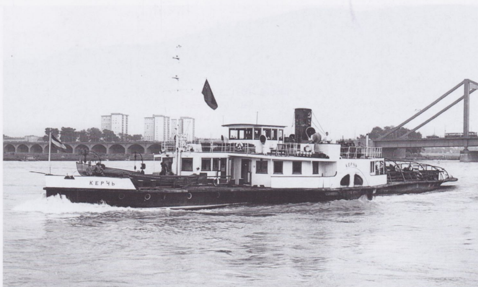
De 450 pk sterke Sovjet-radersleepboot KERTSCH werd in 1956 gebouwd op de werf Obuda (Hongarije). Afmetingen: 57,90 x 17,52 m (incl. raderkasten). Vermoedelijk was dit een oliegestookte boot met één pijp. De boot was tot het einde van de jaren zestig nog in actieve dienst.
