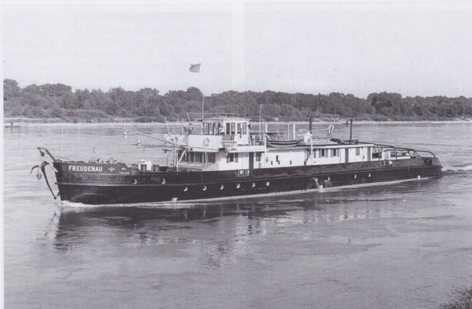
De FREUDENAU (de 2e bij de DDSG) kwam op 30 mei 1942 van de werf in Linz met 46,60 x 7,22 m en 2 MWM-motoren van 410 pk. De boot maakte deel uit van de N-serie van 22 boten die volgens het 'Reichsbauprogramm' werden gebouwd. In 1966 voorzien van 2 x 550 pk Deutz en is nu onderdeel van het scheepvaartmuseum in Regensburg.
