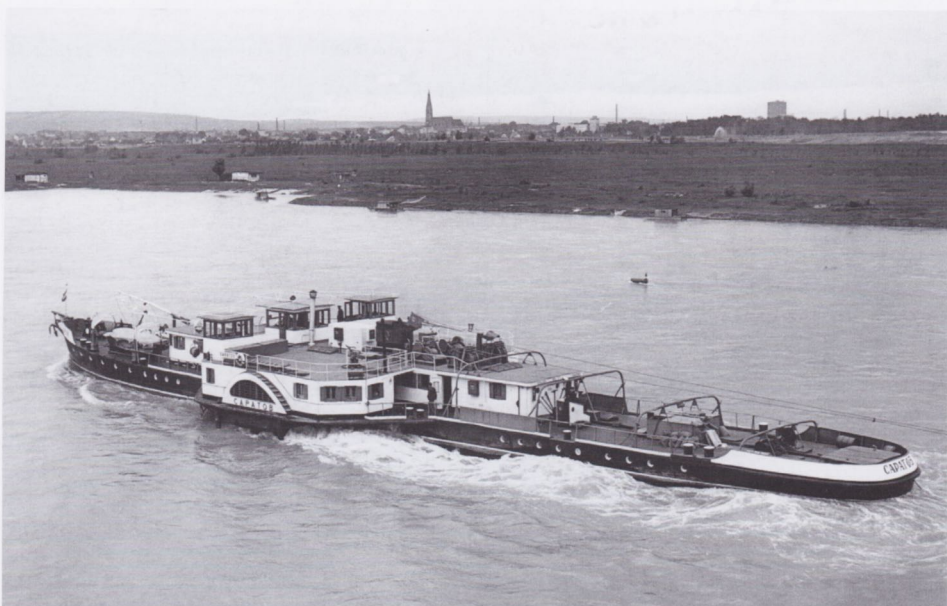
De Sovjetsleepboot SARATOV zou na de bouw in Korneuburg in 1945 (ook als onderdeel van de R-serie) GOLDEGG bij de DDSG gaan heten, maar de boot viel direct al als oorlogsbuit in handen van de Sovjets. Afmetingen: 66,10 x circa 17 m (zonder raderkasten 7,65 m), 2 x 500 pk. Hetzelfde gebeurde met de GLANEGG die als IZMAIL ging varen.
