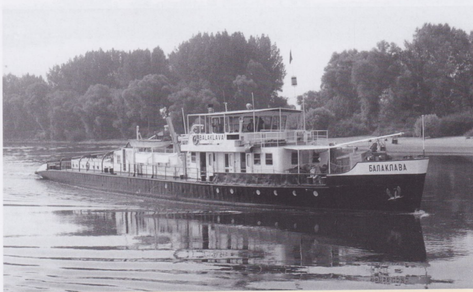
Ook de Sovjetsleepboot BALAKLAVA was onderdeel van een grotere serie, waarvan er 12 voor de SDGP (later SDP) op de Oostenrijkse werf Korneuburg werden gebouwd. Deze boot ging in 1967 te water. Gegevens: 52,07 x 7,50 m; 2 x 525 pk. Sommige boten werden later van duwknieën voorzien en zijn nog steeds actief.
