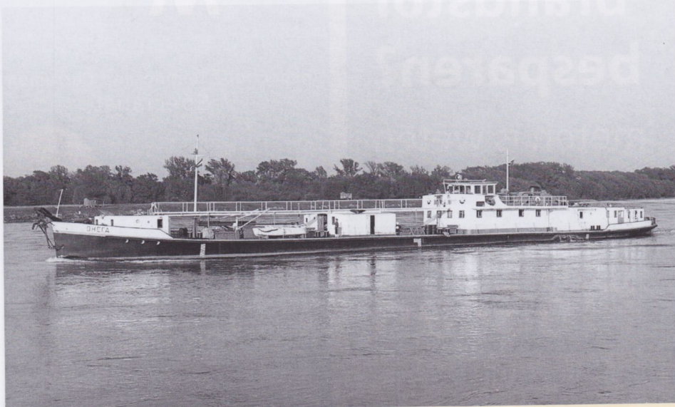
Ook het tankschip ONEGA van de Sovjetrederij SDGP was gebouwd om tevens als sleepboot te fungeren. Gegevens: 70,90 x 9,03 m; 832 ton; 2 x 550 pk. In 1940 ging het schip bij de Deggendorfer Werft te water als IRMGARD WALLNER voor de Duitse rederij Josef Wallner. In 1945 kwam ze in handen van de Sovjets.
