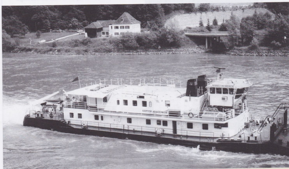
De SERGEJ AVDEENKOV werd samen met 7 identieke soortgenoten gebouwd in Belgrado tussen 1974 en 1976. De boten gingen varen voor de SDP en varen tegenwoordig voor de Oekraïner UDP. De stuurhut is hydraulisch op- en neer beweegbaar. Ze zijn 3000 tot 3240 pk sterk en hebben de afmetingen 38,50 bij 11,00 m.
