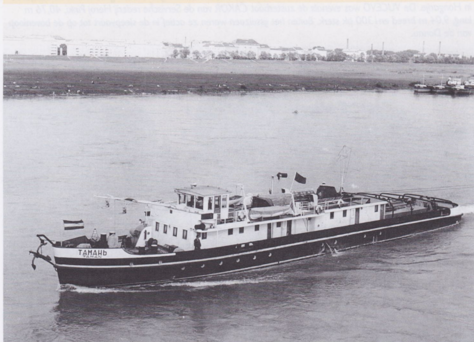
TAMAN was de naam van een Sovjetsleepboot die in 1941 in Linz was gebouwd voor de DDSG en toen AL-TENAU ging heten. Bij het oorlogseinde ging de boot naar de Sovjets en heette sindsdien bij de SDGP (later SDP) TAMAN. Gegevens: 46,60 x 7,27 m; 2 x 410 pk. De boot voer over het hele Donautraject tot aan Regensburg.
