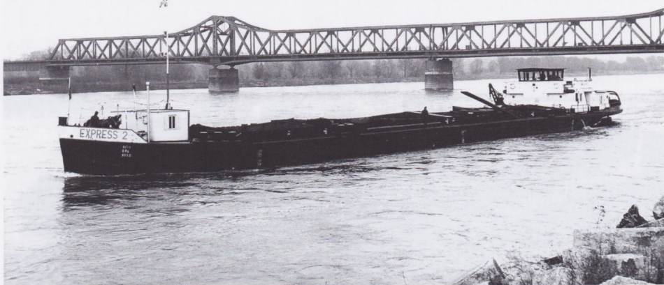
In 1963 liet de Bayerische Lloyd zeven sleepschepen ombouwen tot motorschip, de EXPRESS 1 t/m 7. Hier de EXPRESS 2. De schepen kregen een MWM-motor van 750 pk ingebouwd en konden ongeveer 825 ton vervoeren. Ze waren 74 m lang en 9,5 m breed. Ze namen vaak een sleepschip mee en deden tot eind jaren zeventig dienst.
