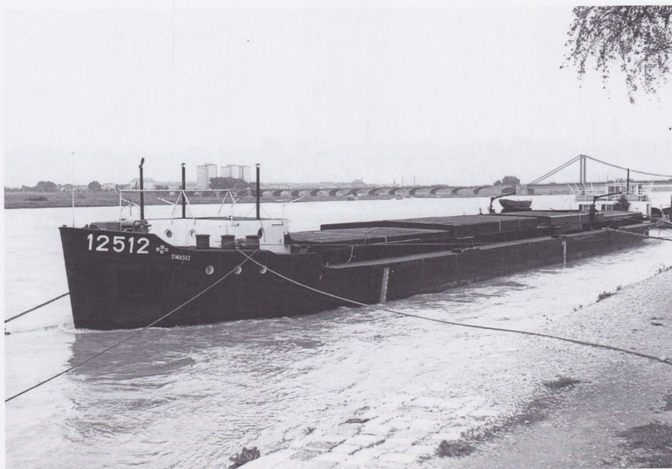
Het sleepschip 12512 van de DDSG was, zoals uit de naam valt af te leiden, volgnummer 12 uit de serie sleep-schepen van 1250 ton. Die 19 schepen werden vanaf 1960 gebouwd. Op deze foto tijdens de Pinksterdagen 1962 in Wenen was dit schip net nieuw opgeleverd. De DDSG had toen ca. 140 sleepschepen.
