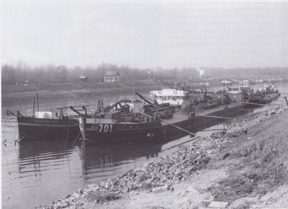
Het motortankschip DEGGENDORF van de Duitse rederij Wallner was met haar 1000 pk sterk genoeg om naast de eigen lading van maximaal 646 ton ook sleepschepen mee te nemen. Hier heeft het schip met drie tanklichters, waaronder de BL 701, ligplaats gekozen. Het schip werd in 1929 in Regensburg gebouwd. De foto stamt uit de winter van 1953.
