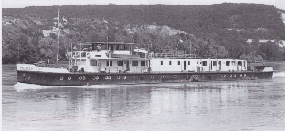
Ook de Tsjechoslowaken beschikten over diverse grote motorsleepboten, zoals de hier afgebeelde MURÁN 2 x 550 pk sterk, 57,10 m lang en 9,03 m breed. De boot ging in 1960 te water bij de werf Komárno. Dit was echter niet de sterkste sleepboot van de CSPD, want dat was de KRIVÁN met 3 x 600 pk.
