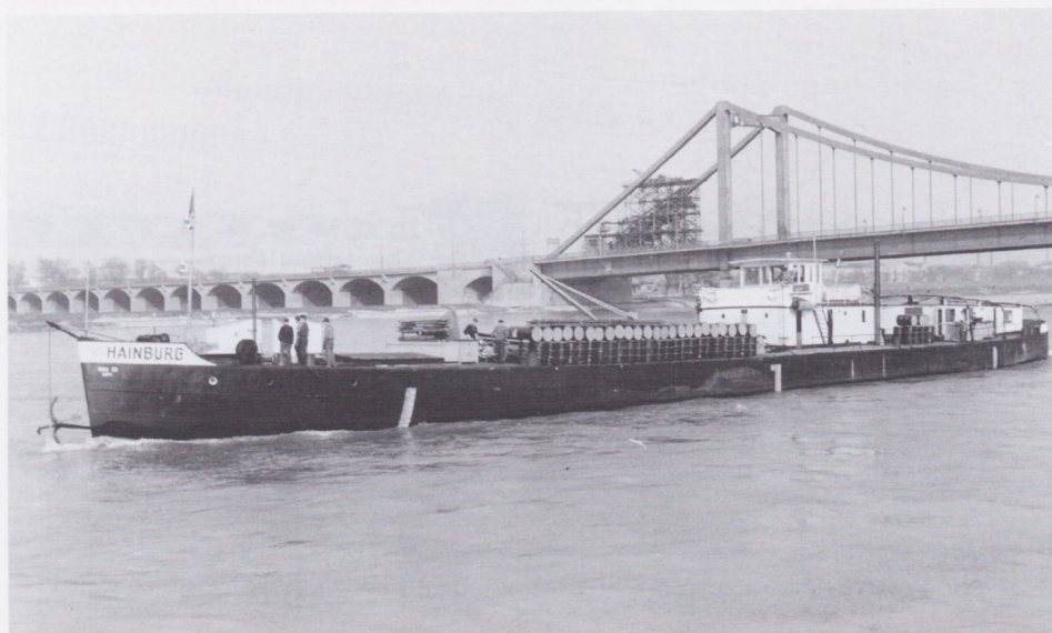
De HAINBURG van de DDSG werd in 1939 overgenomen van de SDG, samen met twee zusterschepen, en van 2 Deutz-motoren van 220 pk voorzien. Deze schepen waren 60 m lang, 8,10 m breed. De tonnage is onbekend. Al in 1912 werden de schepen in Regensburg gebouwd. In 1971 werd de HAINBURG verkocht.
