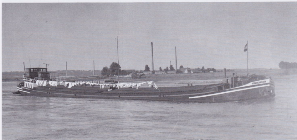
Het met een mooie zeeg voorziene sleepschip SAN ANTONIO werd in 1909 werd opgeleverd door Scheepswerf J. Meijer te Zaltbommel/Leeuwen aan de heer A. Snijders te Den Bosch. Het laadvermogen bij oplevering bedroeg 1734 ton en het schip had toen 12 laadruimen. Het schip is gedurende zijn bestaan altijd eigendom geweest van de familie Snijders en in 1980 gesloopt. Opvallend veel van dergelijke voor die tijd grote sleepschepen hebben voor de stuurhut een soort van buitenruimte op het roefdek staan. Hiervoor rouleren vele benamingen als 'hypotheekhuisje', rooksalon of de plek waar de 'herenschipper' door een luik aan de achterzijde aanwijzingen zou geven aan de roergangers. We zijn in het bezit van meerdere dergelijke foto's. Wellicht mogen we van de leden horen welke functie die vaak uit mooi teakhout bestaande ruimtes hadden.
