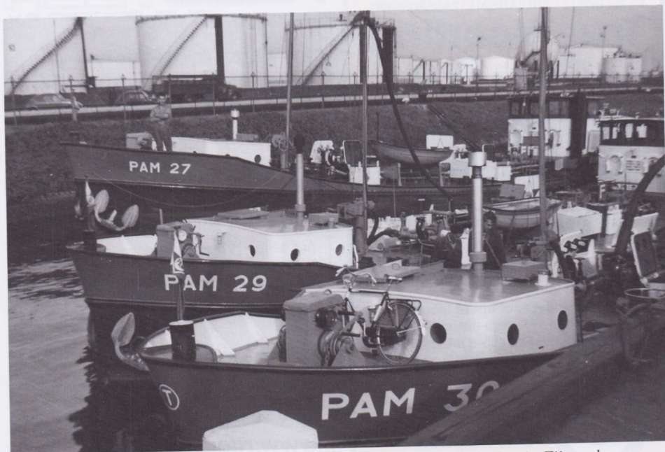
De motortankschepen PAM 27, 29 en 30 liggen aan de Caltexsteiger in Pernis. Zij werden voornamelijk ingezet voor de bevoorrading van bunkerstations. Deze fraaie ca. 160 ton grote en van een 100 pk Bolnes-motor voorziene schepen zijn gebouwd bij Scheepswerf Timmer in Delft. Op deze werf zijn veel van dergelijk schepen en bunkerboten gebouwd. Foto: Auke Zandstra.
