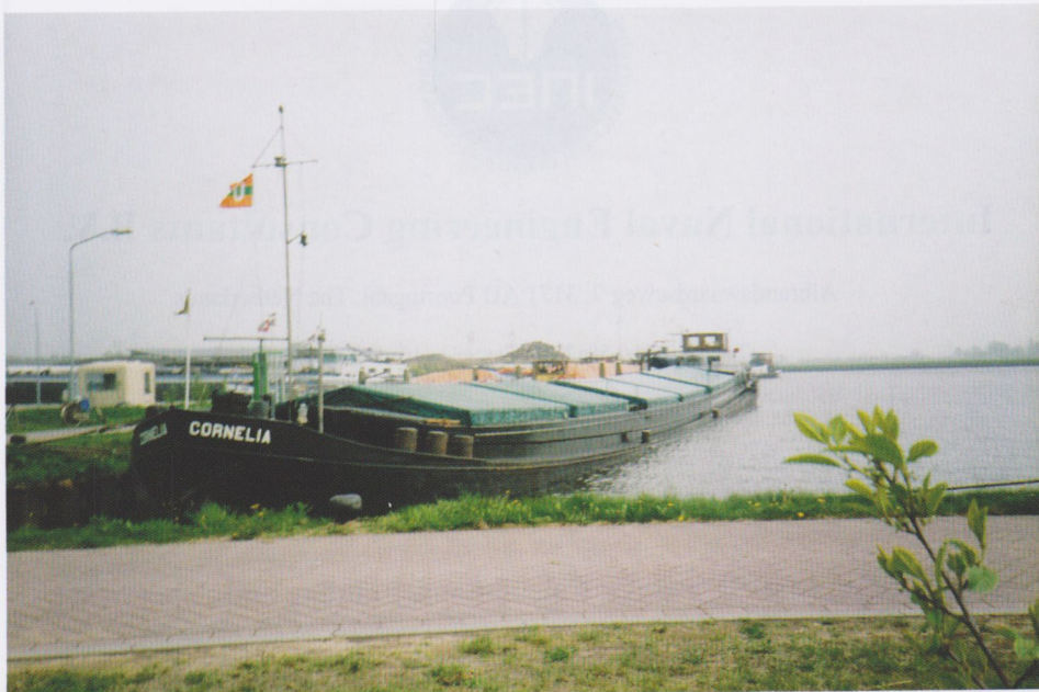
De CORNELIA werd in 1910 als sleepschip in Leiderdorp gebouwd. De afmetingen 59,26 x 7,93 x 2,33 gaven het schip een tonnemaat van 726 ton. In 1973 werd het schip voorzien van een 244 pk sterke Caterpillar. De opeenvolgende eigenaren waren C. Smits, H.C. Smits en C.W.A. Smits. Het schip is in juli 1997 in s'-Gravendeel bij de firma Timmerman gesloopt. Foto: C. Smits.
