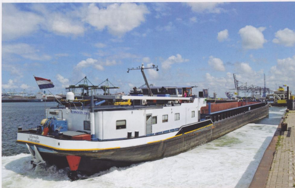
Ook de MERWEDE (02309434) van Vof. Cornet-Baggerman is gebouwd als sleeptankschip voor Van Ommeren. In 1971 tot motortankschip omgebouwd bij Piet Hein in Bolnes. In 1981 tot motorvrachtschip omgebouwd bij De Biesbosch in Dordrecht. Ze kreeg een nieuw voor- en middenschip. Het middenschip is gebruikt als ponton onder het Chinees Indisch restaurant Ocean Paradise aan de Parkhaven in Rotterdam.
