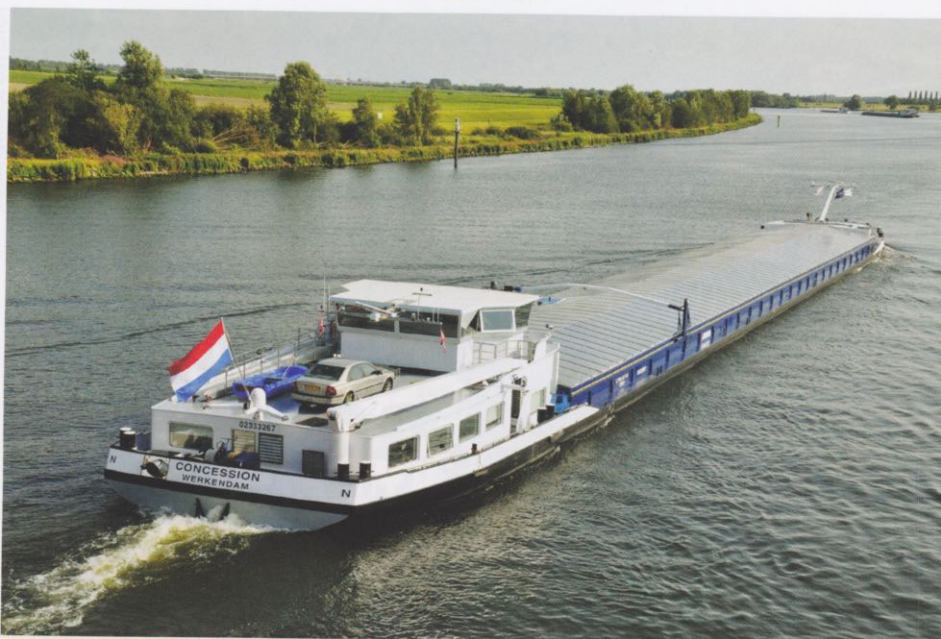
Een van de nieuwste schepen uit Werkendam is de CONCESSION (0233267) van Transito Handel BV. Het casco van dit schip is in Polen gebouwd en de afbouw vond in 2011 plaats bij Instalho in Werkendam.
