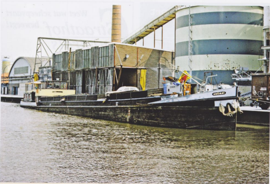
De AHUMAI van W. van den Heuvel tijdens het lossen in de Oosterhaven te Winschoten. Zij kwam in 1930 in de vaart als SIMPLON van de Basler Rheinschiffahrt AG in Basel. Het scherpe schip was gebouwd voor de vaart op Basel en was voorzien van een 250 pk sterke Sulzer motor. In 1999 is zij als BUITENBURCHT gesloopt.
