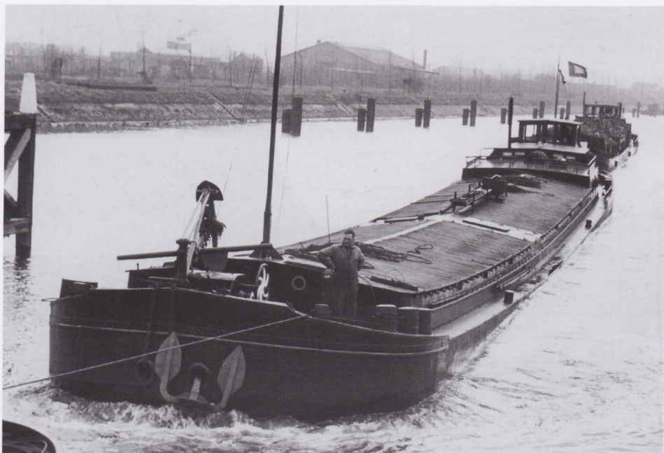
BANJAK (2304639) 50,00 x 6,99 x 2,36 – 557 ton / eig. NV Scheepsexploitatie Mij Rotam Dir. J. Müller in Heumen. In 1930 gebouwd voor delfde eigenaar bij De Korte in Moerdijk.
