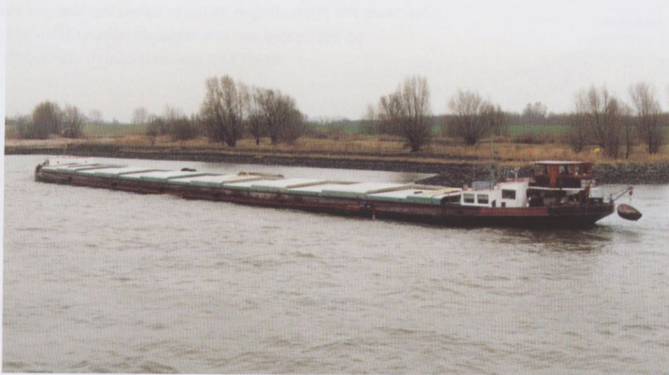
LINUS (2308122) 110,00 x 13,10 x 3,10 – 3168 ton / eig. Linus Scheepvaartbedrijf BV in Zuilichem. In 1912 gebouwd als PARSIFAL voor de Nederlandsche Transport Maatschappij NV in Rotterdam bij van der Giessen, Krimpen a/d IJssel. Dit is momenteel het grootste nog actief zijnde sleepschip.
