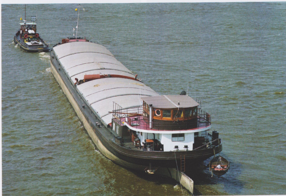
RISQUONS (2303007) 88,00 x 10,90 x 2,67 – 1753 ton / eig. T.G.M. Verschure in Rotterdam. In 1928 gebouwd als RISQUONS voor G.M. Verschure in Waspik bij Ruijtenberg, Waspik. Thans in de vaart als duwschip.
