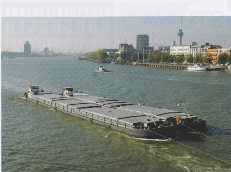
ST. MARIA (2304211) 80,00 x 9,50 x 2,53 – 1318 ton / eig. J.A Joosten in Rotterdam. In 1929 gebouwd als ST. MARIA voor J.A Joosten in Rotterdam bij De Groot & van Vliet, Slikkerveer. Op 22-10-2007 passeerde zij samen met de HASARD de Erasmusbrug in Rotterdam wat unieke plaatjes opleverde.
