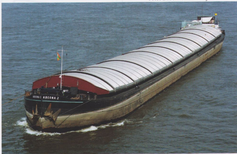
ABEONA 2 (2303482) 110,15 x 13,10 x 2,90 – 2922 ton / eig. F.J. & J.H. Hoenderop in Rotterdam. In 1914 gebouwd als TITUREL voor de Steenkolen Handels Vereniging in Rotterdam bij van der Giessen, Krimpen a/d IJssel. 1996 gesloopt.
