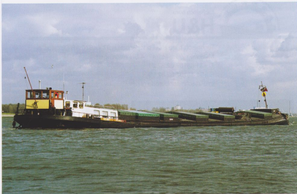
SIRIUS (2302646) 76,58 x 9,83 x 2,39 – 1222 ton / eig. J. Keller in Rotterdam. In 1908 gebouwd als SIRIUS voor J.B. Keller in Lobith bij Kalkman, Capelle a/d IJssel. 1996 gesloopt. Foto: Teun van der Zee
