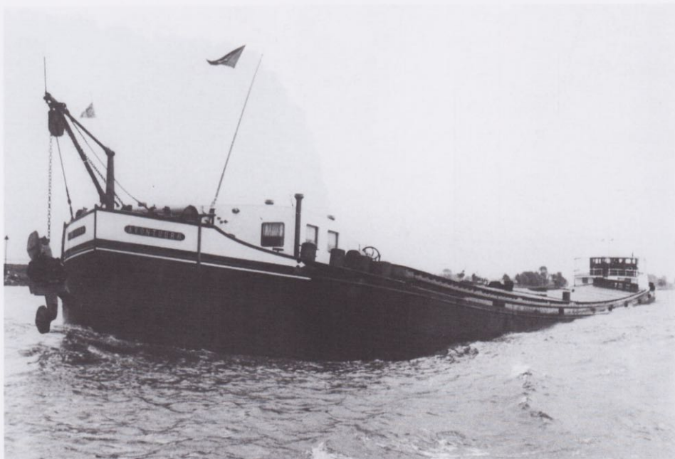
AVONTUUR 6 (2303314) 113,44 x 12,65 x 3,04 – 2991 ton / eig. B.M.P. van Ooijen in Bolnes. In 1928 gebouwd als AVONTUUR 6 voor W.J. van Ooijen in Rotterdam bij De Merwede, Hardinxveld. Dit was destijds het grootste particuliere sleepschip. Sinds 1980 in de vaart als CHRISTINA van Hazewindus in Rotterdam. Thans in de vaart als duwschip.
