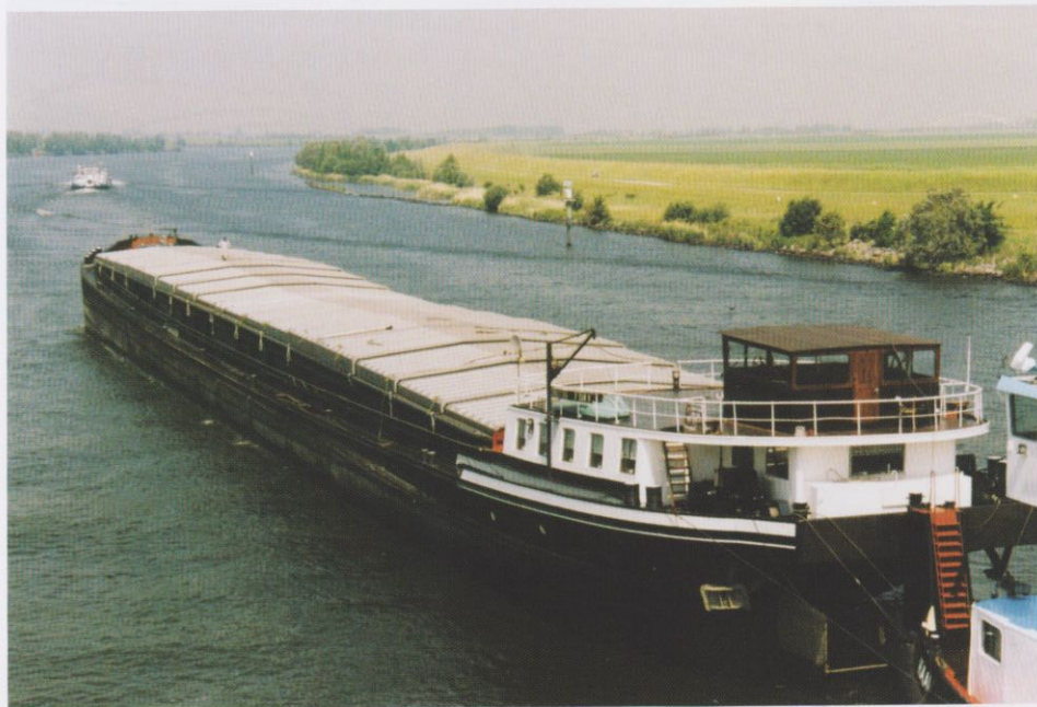
AVONTUUR 6 (2303314) 113,44 x 12,65 x 3,04 – 2991 ton / eig. B.M.P. van Ooijen in Bolnes. In 1928 gebouwd als AVONTUUR 6 voor W.J. van Ooijen in Rotterdam bij De Merwede, Hardinxveld. Dit was destijds het grootste particuliere sleepschip. Sinds 1980 in de vaart als CHRISTINA van Hazewindus in Rotterdam. Thans in de vaart als duwschip.
