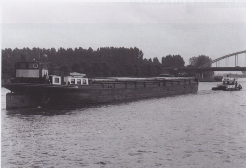
PANTA RHEI (2304774) 80,00 x 9,50 x 2,53 – 1371 ton / eig. E.P.J Volker in Rotterdam. In 1930 gebouwd als SEAM 9 voor Seam Scheepvaart & Agentuur Maatschappij NV in Rotterdam bij De Groot & van Vliet, Slikkerveer. Thans in de vaart als duwschip. Foto: Leo Schuitemaker
