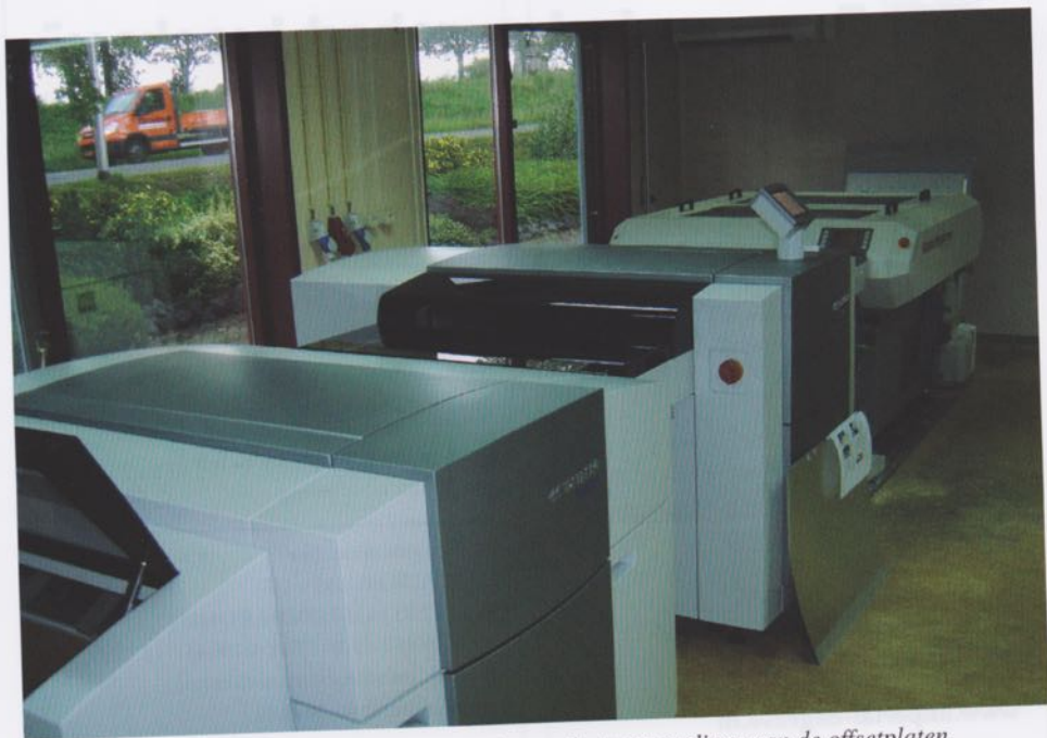
Hier de belichter (een direct to plate systeem), voor het vervaardigen van de offsetplaten.
