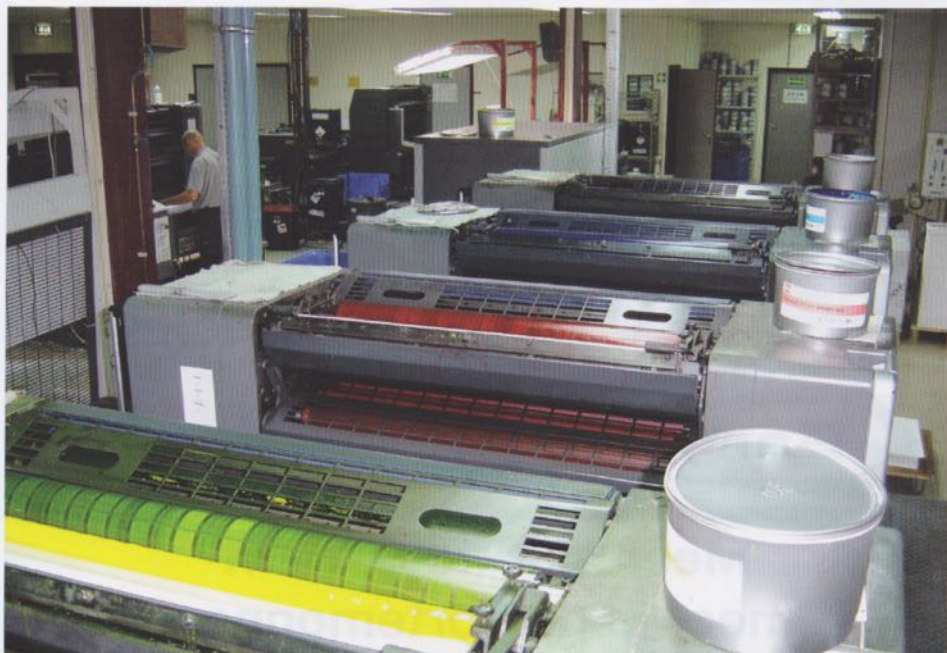
Inktwerk; de vier torens worden van inkt voorzien, zwart, cyaan, magenta en geel.
