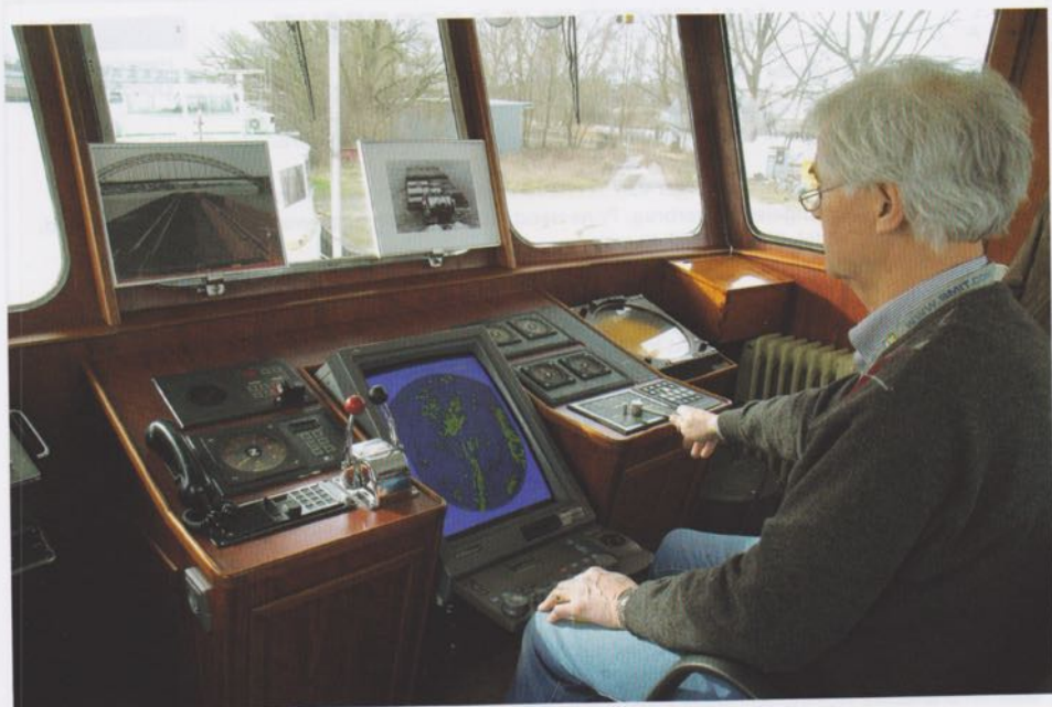
Er is een werkende JMH 608 Color River Radar in de stuurhut geïnstalleerd. Jan Bosman, één van de vaste vrijwilligers van het Binnenvaartcentrum, houdt onze duwboot op de juiste koers.
