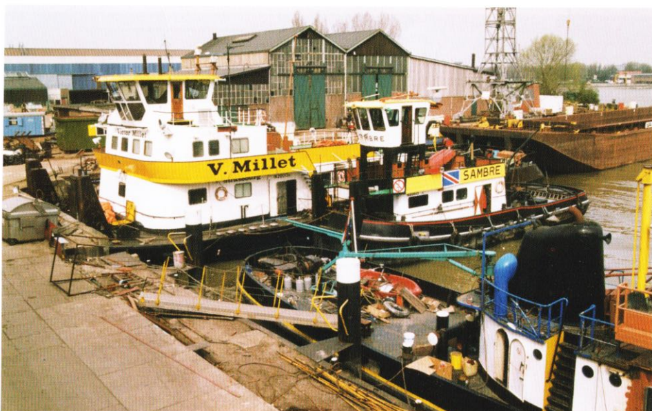
Hier nog een voorbeeld van bedrijvigheid voor de duwvaart. De duwbotten SAMBRE en VICTOR MILLET liggen voor onderhoud aan de werf. Op de voorgrond zien we de ombouw van sleepboot naar duwboot van één van de MAASSTROOM duwbotten. Foto: Leo Schuitemaker (15-04-1988)
