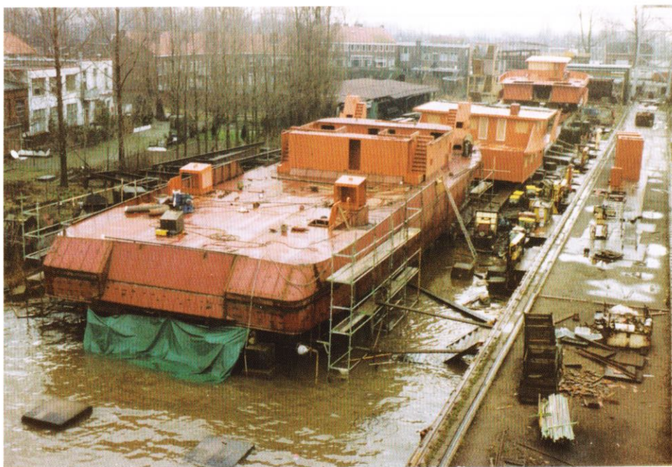
Hier zien we de specialiteit van de werf in de latere jaren, het bouwen van duwboten. Als deze onderdelen zijn samengevoegd ontstaat in 1982 bouwnummer 751, de duwboot ALBERT AUBERGER.
