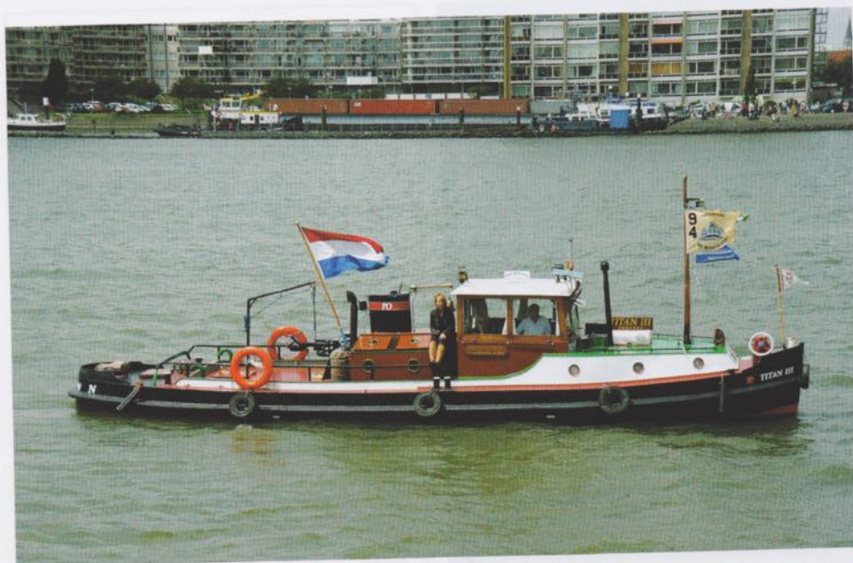
Nummer 94, TITAN III (2003587) van P. Ouderkerk in Rhon. Gebouwd in 1937 bij de RDM in Rotterdam. Getekend door de School ter opleiding van scheepsbouwers 'Nicolaas Witsen' in de Oranjeboomstraat in Rotterdam. De boot is een van de eerste gelaste schepen.
