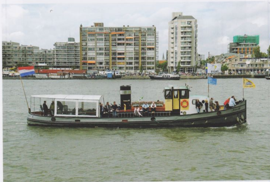
Nummer 37, JAN B (2008141) van Breko Nieuwbouw BV in Papendrecht werd in 1927 gebouwd als motorsleeptboot M 206 voor het Reichsschleppbetrieb in Münster. In deze voormalige 'Monopol'-sleeptboot staat nog steeds de eerste motor (360 pk Deutz). Foto: Jan van Doremalen.
