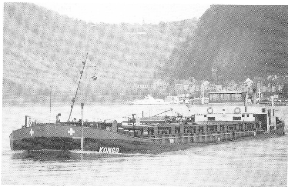
mvs KONGO (7000566) afvarend te St. Goar. 1958 J Boel & Zn - Temsche / 85.64x11.05x2.75/3.22 m / 1595/2021 ton / 2x600 pk Sulzer / KONGO. Schweizerische Reederei AG / Basel / 28-11-'85 VAGARI (2317635) Vagari VOF / Krim- pen a/d IJssel / 1997 SANITAS. Lingen VOF / Ridderkerk. Foto Teun de Wit
