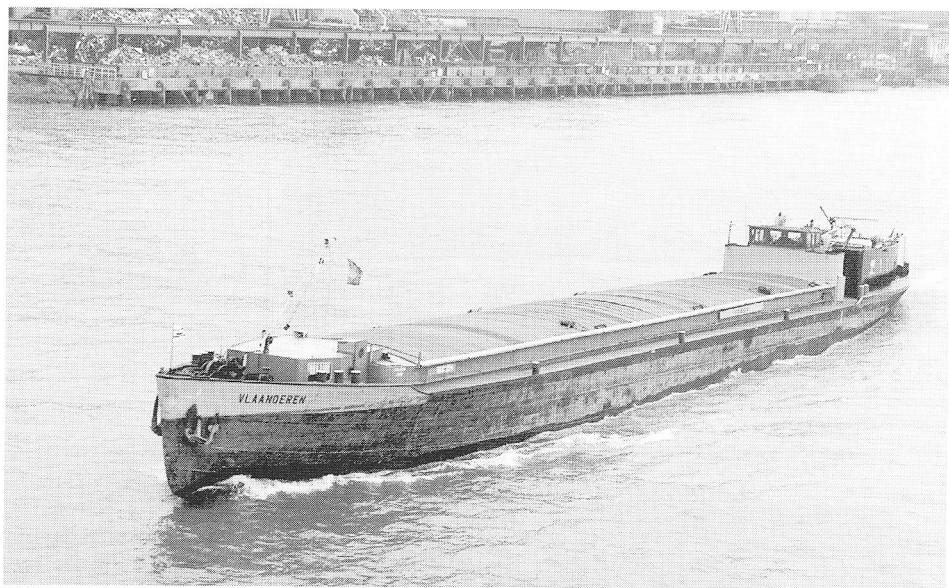
mvs VLAANDEREN (6002294), van het type 'Franse motor' afvarend te Alblasserdam. 1950 De Biesbosch - Dordrecht / 73.50x8.16x2.63/2.82 m / 820/993 ton / 480 pk Enterprise / 429 pk SKL / SAUTERNES (554 F Strasbourg). Le Rhin Ste. Generale de Navigation & d'Entrepots / Strasbourg / VLAANDEREN. R. de Wit / Brugge. Foto Willem Keizer
