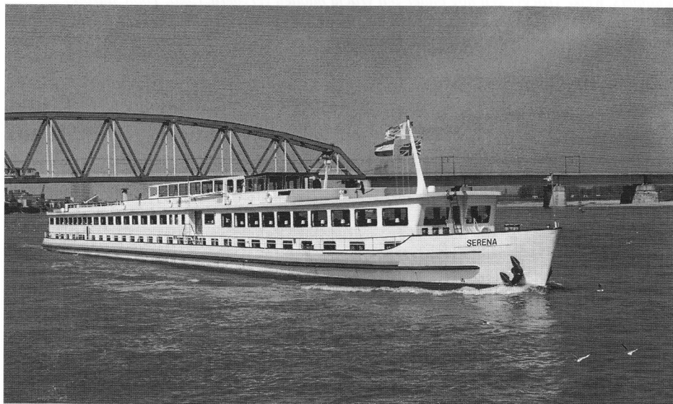
De nieuwste aanwinst van Rederij Boonstra, de SERENA. Hier nog onder Zwitserse vlag bij de vorige eigenaar. Het schip is in Rijnvaartkringen geen onbekende. Ze werd in 1949 bij Jos Boel in Temsche gebouwd als motorsleepboot UNTERWALDEN voor rekening van de Schweizerischer Reederei AG te Basel. Voorzien van 4 x 1000 pk was zij de sterkste sleepboot van de Rijn. In de jaren 1976/1977 werd zij omgebouwd tot mps REGINA RHENI, later is zij verkocht en herdoopt in SERENA.
