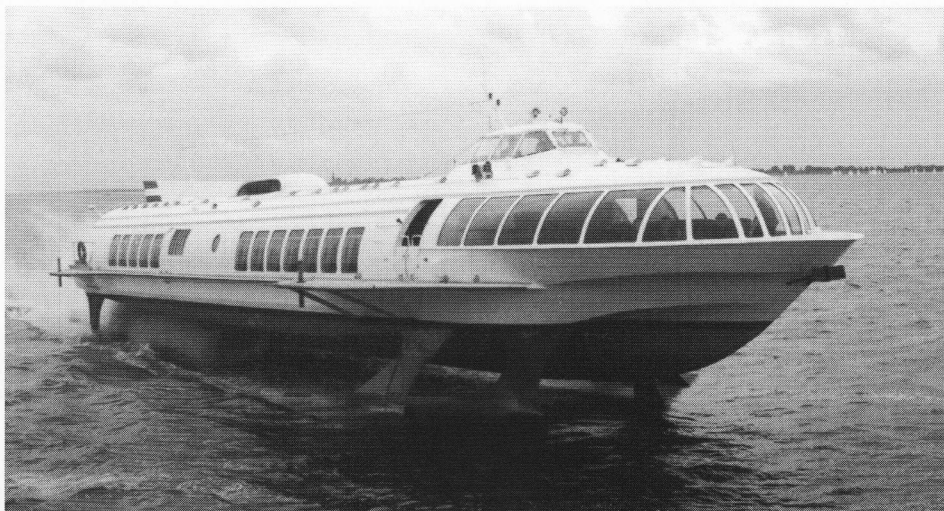
De PRINS WILLEM ALEXANDER (22 07468), ex CITY OF KAMPEN, zoekt hier op volle snelheid over het IJsselmeer. Deze in 1992 in Rusland (Zelenodokka/Volga) gebouwde draagvleugelboot, van het type Meteor, met de afmetingen lxb: 35,75 x 9,50 m wordt voortbewogen door 2 x 1250 pk MTU dieselmotoren en kan 130 passagiers vervoeren. (foto: Rederij Fast Flying Ferries)
