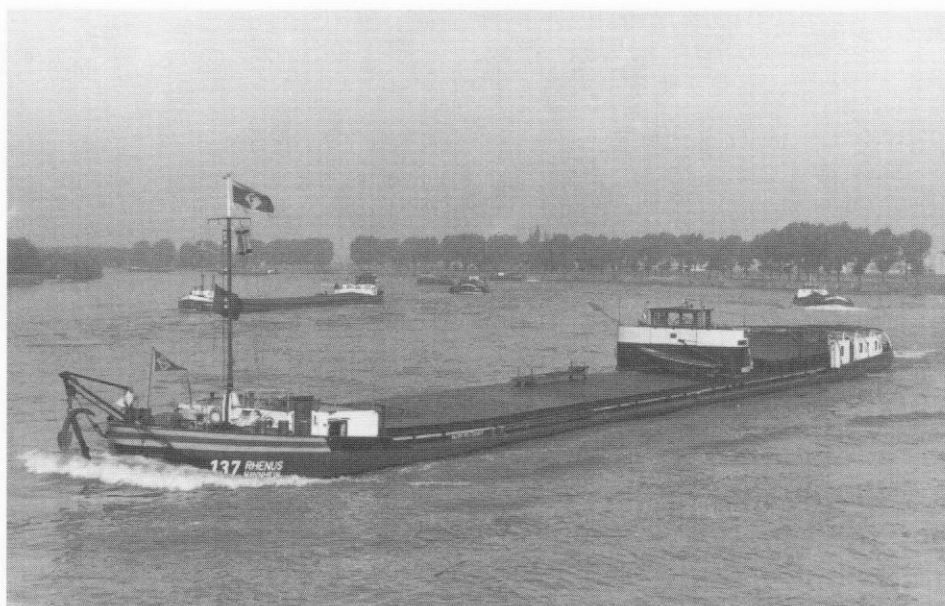
RHENUS 137 (4009510) met sleep opvarend te Gernsheim Foto: Gunter Dexheimer 1956 Schiff & Machinebau AG Mannheim / 79,80 x 9,48 x 2,50 m / 1129 ton / 2 x 550 pk MAN 1972 ombouw tot mts RHEINTANK 30 / 85,00 x 9,50 x 2,70 m / 1560 ton / Stinnes AG/Duisburg 1988 CARRERA 1 Avanti Tankreederei/Wien / vaart thans op de Donau
