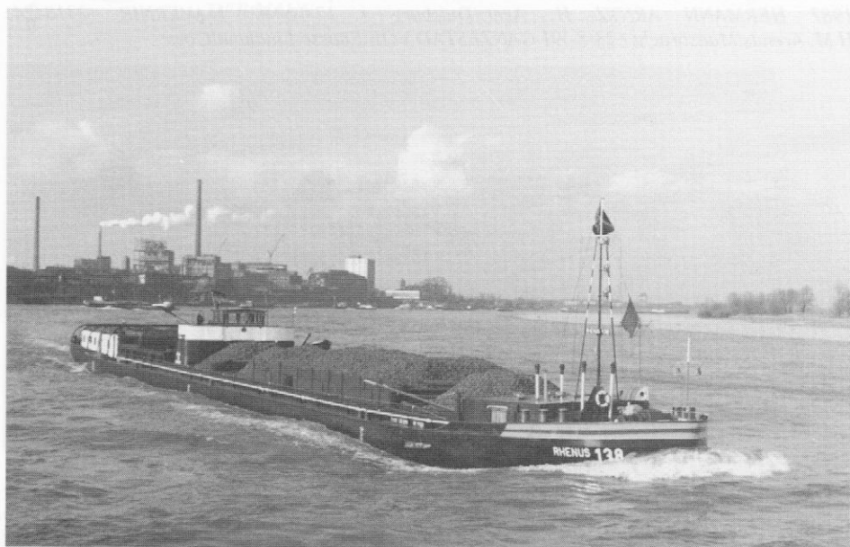
RHENUS 138 (4009520) in de bergvaart te Uerdingen Foto: P.A. van Meel 1956 Schiff & Machinebau AG Mannheim / 79,82 x 9,48 x 2,50 m / 1133 ton / 2 x 550 pk MAN 1972 ombouw tot mts RHEINTANK 31 / 85,00 x 9,50 x 2,70 m / 1527 ton / Stinnes AG/Duisburg 1988 CARRERA 2 Avanti Tankreederei/Wien / vaart thans op de Donau
