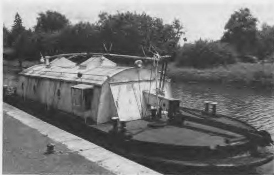
De kettingboot van Pouilly en Auxois de TOUEUR (lxb: 15 x 3,20 m). De originele motor was een omgepoolde dynamo van 550 volt, 19 kW bij 900 toeren. Op 18-09-1987 maakte schipper Mr. Remond er de laatste reis mee. Foto: Hans Schuitemaker
