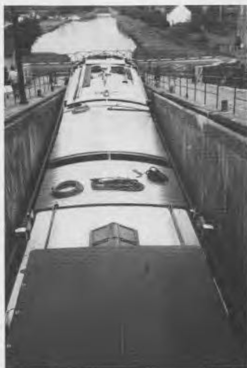
De SALVÉ in de tweetrapssluis te La Guétin. Het schip ligt sterk achterover door ballast. De muur van de onderste kolk loopt schuin naar beneden waardoor het lijkt of het schip met de kop op de drempel hangt. Foto: Ben Boode
