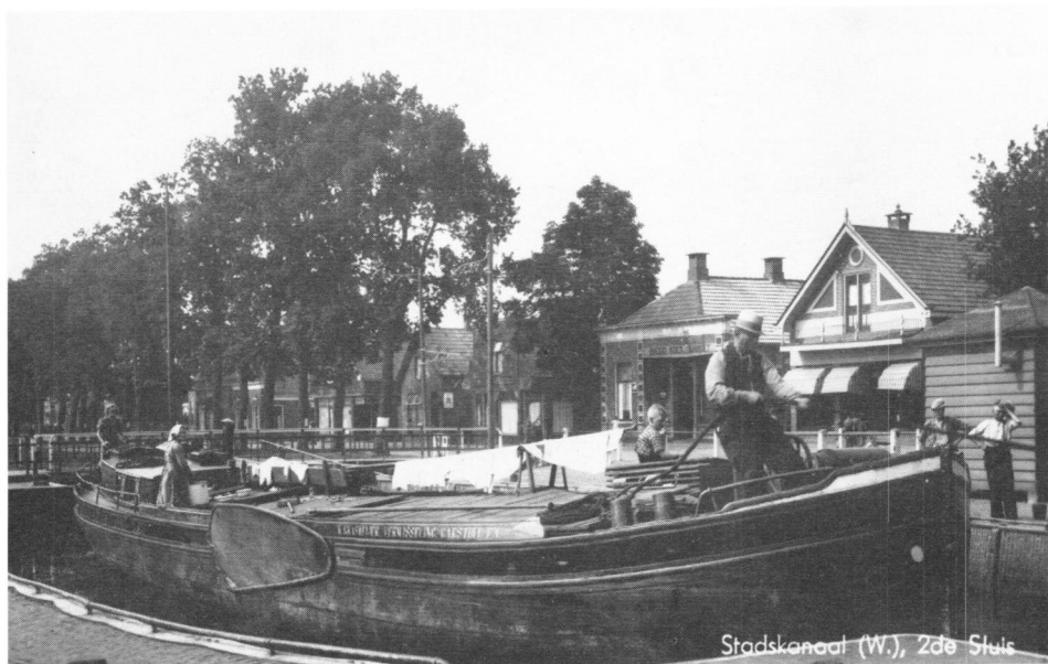
De “ VERWISSELING ” van schipper Grasmeyer uit Garsthuizen wordt hier opgeschut in het 2e Verlaat te Stadskanaal. Schipper Grasmeyer was eigen-handelaar en haalde met zijn steilsteven (56 ton) zelf de turf uit het veen. Het schip was uitgerust met een 9 pk Brons.
