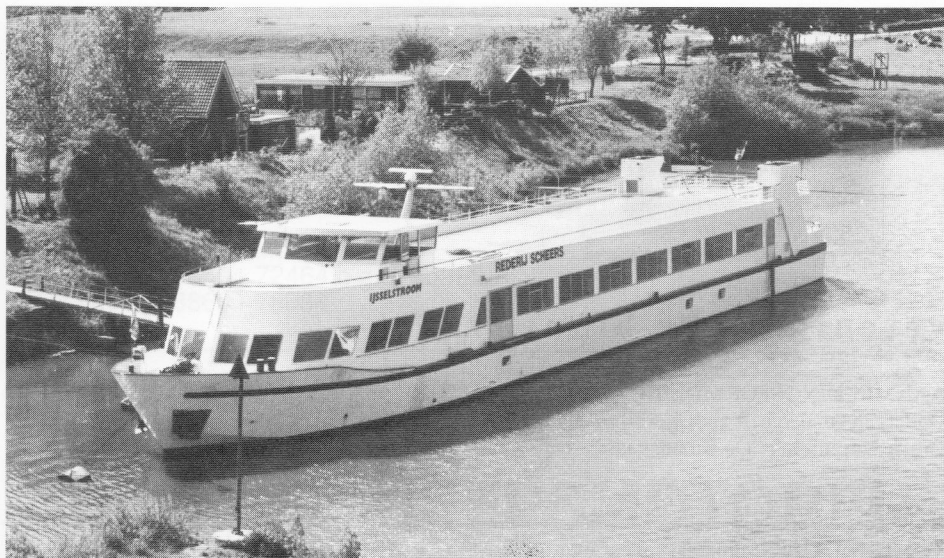
mps IJSELSTROOM 23 19656 Rederij Scheers B.V., Deventer 1990/91 J. Poppen B.V., Zwartsluis 117 ton - 59,95 x 9,62 x 1,13/1,44 m 2 x 370 pk Volvo Penta
