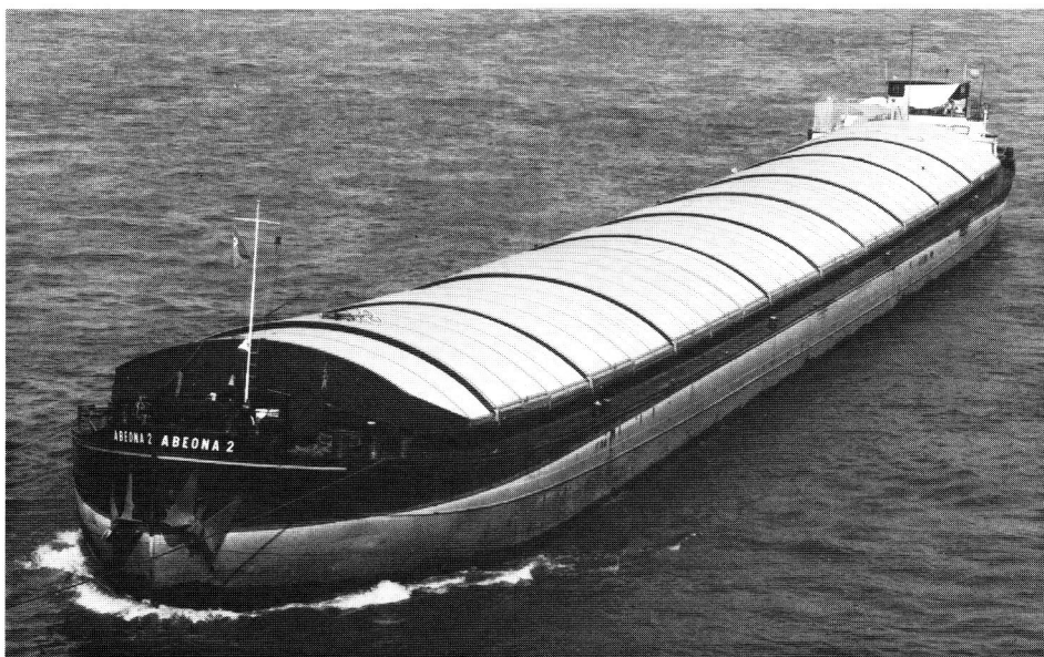
svs ABEONA 2 23 03482 Hoenderop, Rotterdam 1914 v/d Giessen, Krimpen a/d IJssel 2922 ton - 110,14 x 13,08 x 2,90 m ex TITUREL ex SHV 20
