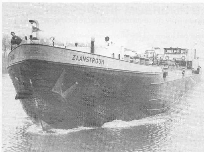
mts ZAA NSTROOM 20 07287 v/d Sluijs Tankrederij BV, Geertruidenberg 1974 Heermans, Hedel 1296 ton - 89,80 x 9,50 x 2,52 m 720 pk Bolnes
