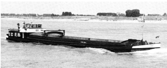
mvs PARMA 23 09447 D. Zuiddam, Rotterdam Opvarend te Xanten 1955 St. Pieter, Hemiksem 561 ton - 52,95 x 6,60 x 2,46 m 365 pk Caterpillar ex DAMCO 252
