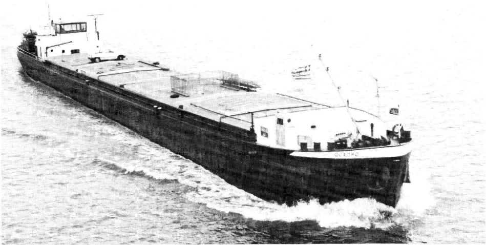
mvs QUADRO 23 17636 VET, Rotterdam 1100 ton - 73,03 x 8,20 x 2,73 m, 660 pk MWM 1957 Bayerischen S.G., Erlenbach Ex EXPRESS 48
