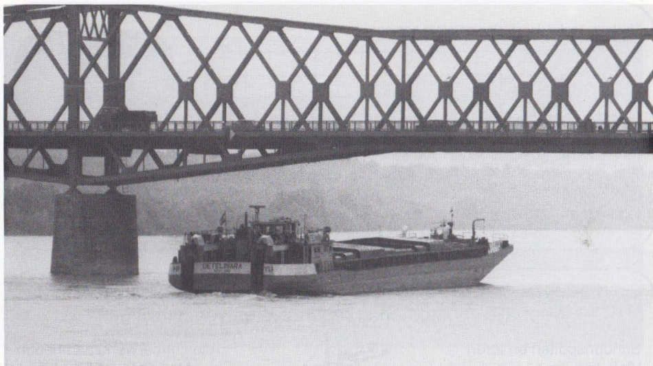
Onder de brug van Dunaföldvár, zo'n 100 km benedenstrooms van Budapest, bevindt zich het afvarige duw-ms "DETELINARA" (76,93 x 11 m; 1400 ton; 640 pk) van rederij Heroj Pinki (HP) uit Novi Sad. Deze kleinere rederij heeft o.a. 2 sleepboten en 3 duwboten in bedrijf. De duw-motorvrachtschepen varen inmiddels tot aan Kelheim (Duitsland) met HP-sleepschepen of -duwbakken.
