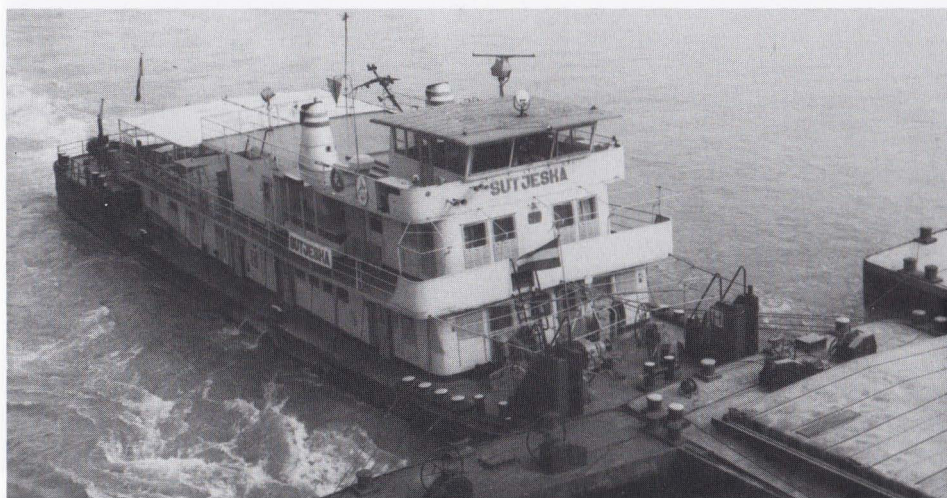
Toen de "SUTJESKA" van de JRB in 1965 in bedrijf kwam, was dit met zijn 3 x 800 pk (38 x 10,26 m) de sterkste Donau-duwboot. Nu zijn de sterkste duwers op de Donau 3300 pk, waaronder ook 3 JRB-duwbotten. Op één van de duwknieën wappert een kleine hongaarse vlag, omdat de duwboot zich op het hongaarse traject bevindt. Dit is een Donau-gewoonte. Achterop de duwboot waait de eigen nationaliteitsvlag zoals ook op de Rijn gebruikelijk is.
