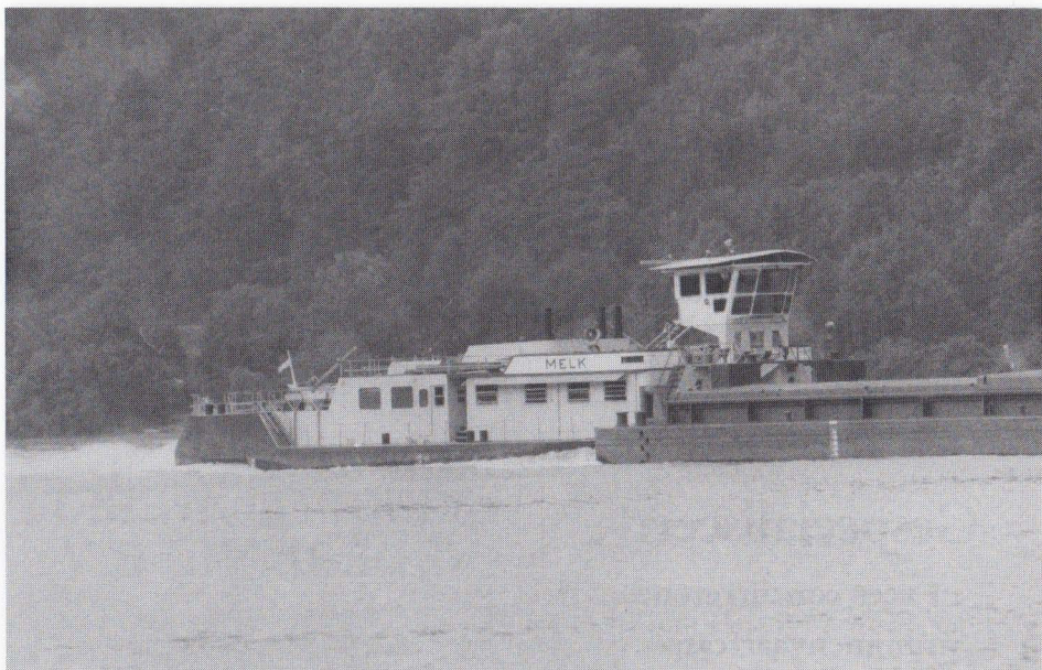
De duwboot "MELK" (32 x 11,4 m; 2700 pk; diepgang 1,5 m) vaart, evenals de andere DDSG-duwboten "Linz", "Ybbs" en "Tulln" (de laatste ex "Gefo Hamburg" van de Rijn), doorgaans op de Boven-Donau om erts-duwbakken die vanaf de Beneden-Donau zijn aangevoerd door de "Stein-klasse", vanaf Komárom verder naar Linz te brengen. De duwboten varen echter soms ook zelf tot aan de Zwarte Zee en zijn ook geschikt voor het Main-Donau-Kanal.
