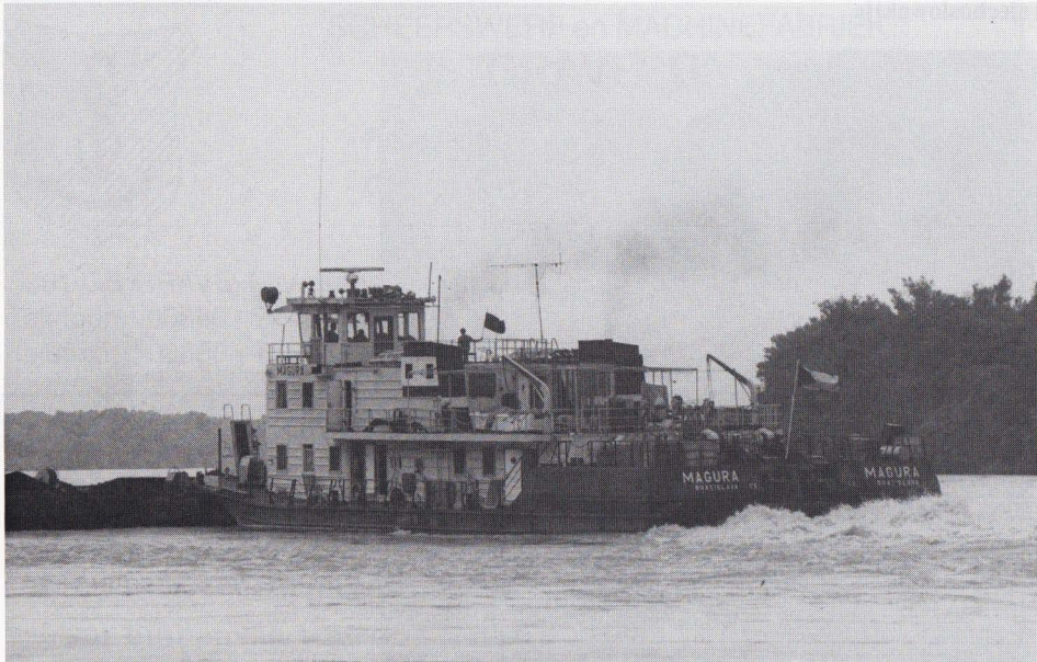
De CSPD-duwboot "MAGURA" (34,60 x 11,15 m; 2200 pk) zwoegt de Donau in Hongarije op met 6 duwbakken. Hoe primitief de Donauvaart vaak aandoet, blijkt hier weer: aan stuurboordzijde van de stuurhut staat een bemanningslid met een blauwe vlag te zwaaien omdat een afvarende tegenligger "aan de verkeerde kant" moet passeren. Het uitklapbare blauwe bord is hier nog onbekend. Ook dit is een boot uit een standaardserie (van 8).
