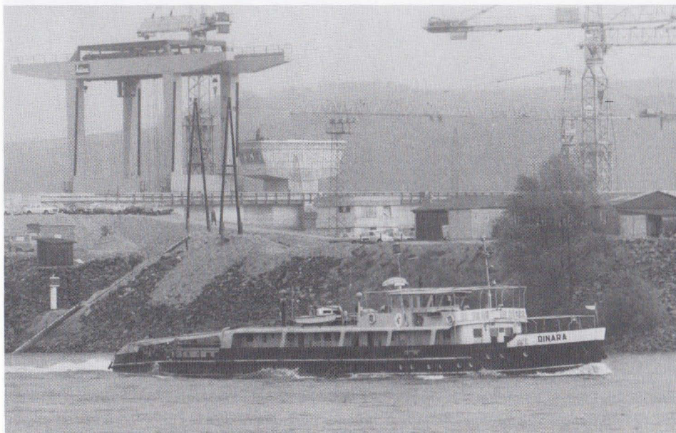
De sleepboot "DINARA" (1600 pk) van de JRB uit Belgrado zwoegt met twee geladen sleepschepen (niet zichtbaar op de foto) de snel stromende Donau op bij de oostenrijkse plaats Melk. Ten tijde van deze foto, in 1981, is op de achtergrond één van de tien grote Donaustuwdammen in het oostenrijkse Donautrajekt nog in aanbouw. Nu schutten de schepen in een grote sluis bij deze stuw en is de stroomsnelheid flink teruggelopen. Rederijkleuren JRB: witte boegkleur, grijze opbouw, schoorsteen met kleuren van joegoslavische vlag.
