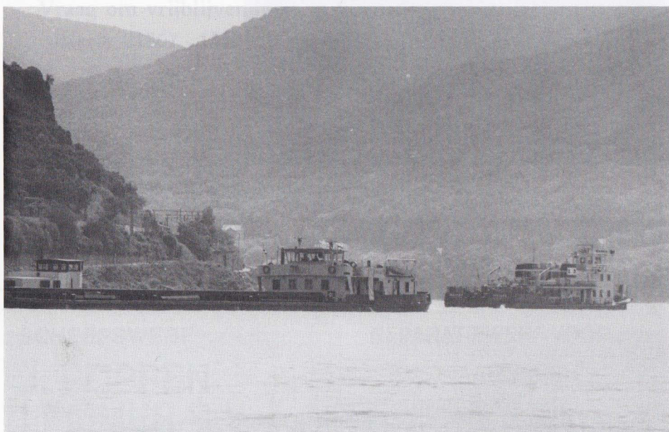
Dezelfde duwboot heeft hier een tsjechisch koppelverband (duw-ms "DUNAJEC" met 2 duwlichten) een handje geholpen tegen het snel stromende water in de hongaarse Donaubocht. Toevallig kwam de duwboot afvarend voorbij en koppelde hij even de duwbakken af. Op de foto heeft de "MAGURA" net losgemaakt. Door de bouw van een stuwdam bij Nagymaros stroomt het water hier nog sneller dan vroeger en is voorspan voor de meeste schepen beslist nodig. De meeste duwkonvooien gaan in twee etappes (twee maal de helft van de bakken) door de Donaubocht. Inmiddels is uit milieu-oogpunt besloten de bouw van de dam stil te leggen. De scheepvaart zit inmiddels met de nog snellere stroom opgescheept.
