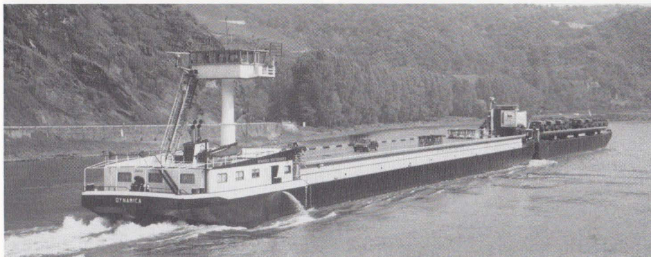
mVs DYNAMICA 22 04503 Rijntrailer Transport, Rotterdam 1973 De Kaap BV, Meppel 1453 ton 104,35 x 11,40 x 2,40 m 2 x 1000 pk
