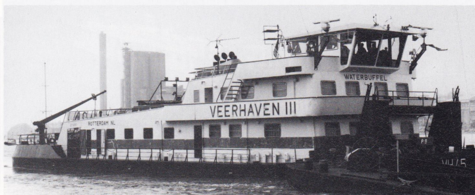
DBO VEERHAVEN III/ WATERBUFFEL 23 14567 Veerhaven BV, Brielle 1976 Ruhrorter Schiffswerft, Duisburg (D) 5400 pk 40,00 x 13,05 x 2,29 m
