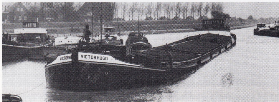
SLS VICTOR HUGO 23 02996 Ned. Rijnvaart Ver., Rotterdam 1912 Werf Boele, Slikkerveer 2105 ton 93,71 x 11,58 x 2,76 m
