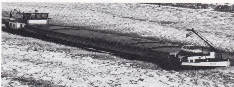
mVs ED-RON 23 14995 T. de Vries, Lemmer 1954 Schiffswert Oberwinter, Oberwinter (D) 1137 ton 80,25 x 8,24 x 2,54 m
