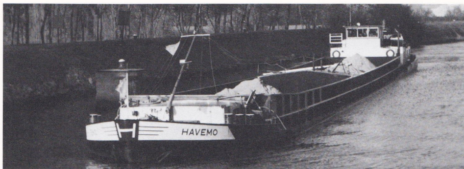
mVs Havemo 23 12727 J.H. van Wijck, Rotterdam 1960 Werf de Rupel, Boom (B) 994 ton 73,05 x 8,20 x 2,54 m
