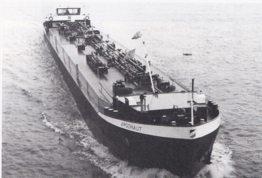
mTs ARGONAUT 33 10488 M. de Goey, Waspik 1964 H.H. Bodewes, Millingen 1499 ton 90,00 x 9,09 x 2,77 m
