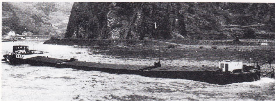
SLS MARTIN 23 02250 G.J. Mötter, Rotterdam 1910 Vuijk & Zn., Capelle a/d IJssel 1260 ton 80,56 x 9,93 , 2,34 m
